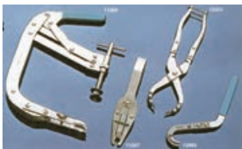
شکل (۱-۷) فنر جمع‌کن سوپاپ
