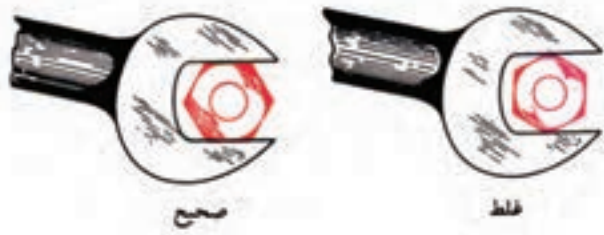
شکل (۱-۵۰) استفاده ی صحیح و غلط از آچار
