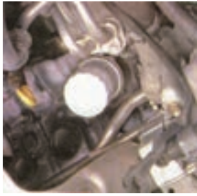
شکل (۲-۶۰) کنترل فیلتر از نظر نشتی
