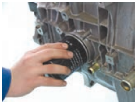
شکل (۲-۵۴) نصب و محکم کردن فیلتر
