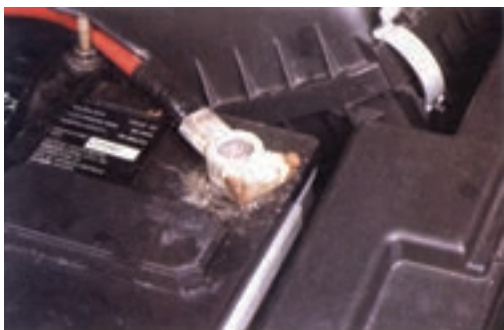
شکل (۲-۸۱) سولفاته شدن بست باتری
