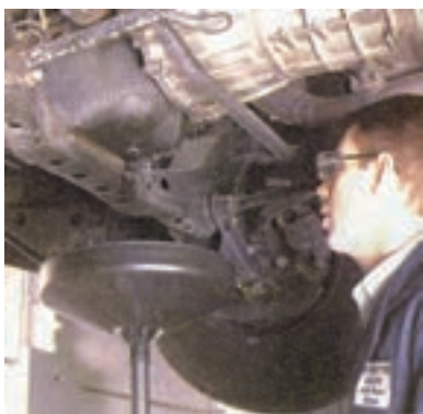
شکل (۲-۵۵) کنترل تخلیه شدن کامل روغن
