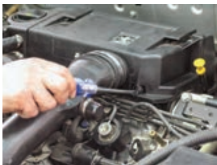
شکل (۲-۶۵) نصب در پوش محافظه فیلتر هوا
