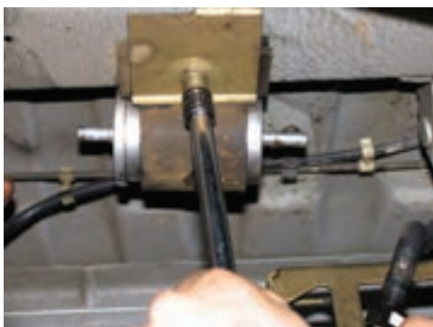
شکل (۲-۶۸) نصب فیلتر جدید
