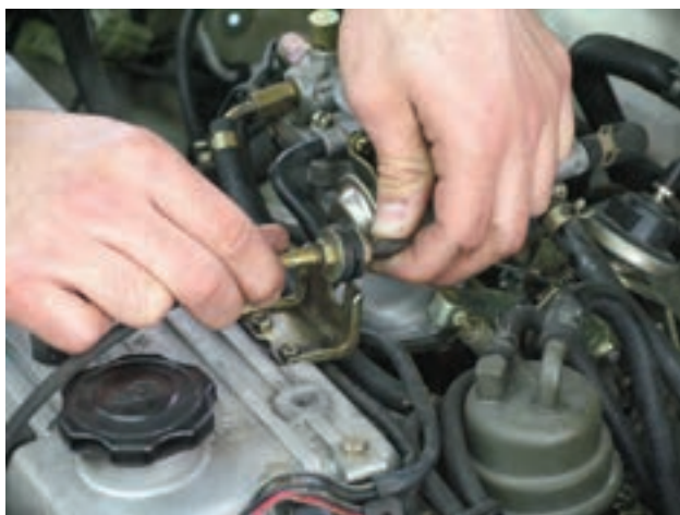
شکل ۱-۱۱۵ پیاده کردن کاربراتور
