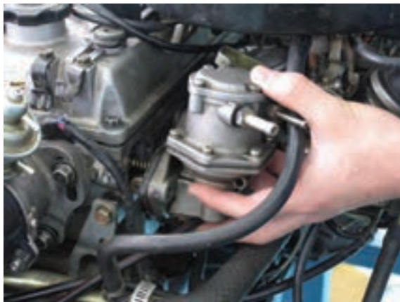
شکل ۱-۴۴ الف: نصب پمپ
