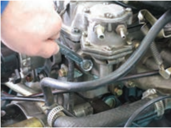
شکل ۱-۴۲ پیاده کردن پمپ
