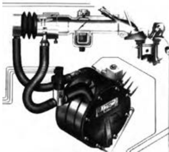
شکل ۱۵-۱- سیستم مخلوط کننده سوخت گاز با هوا
