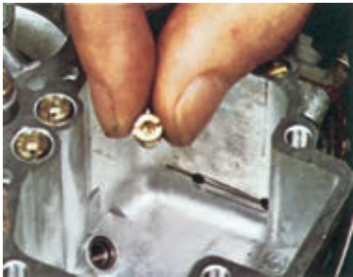
شکل ۱۱۸- ۱ باز کردن ژیکلور اصلی
