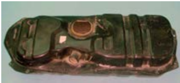
شکل ۱-۲۶ مخزن سوخت آماده نصب
