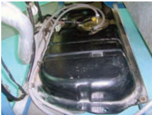
شکل ۱-۲۷ مخزن نصب شده و آماده سوخت گیری
