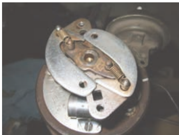
شکل ۲۴-۱۰ دستگاه آوانس وزنه‌ای دلکو
