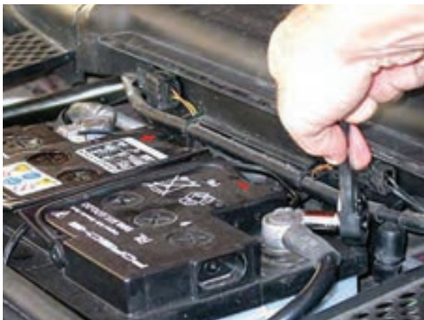
شکل ۱۸-۵- باز کردن کابل اتصال بدنه‌ی باتری
