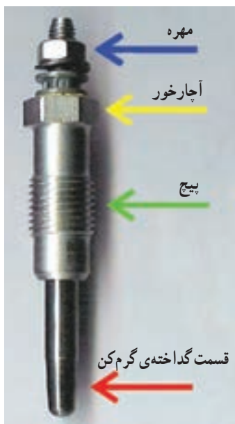
شکل ۲-۱۳- شمع گرم کن موتور دیزل
