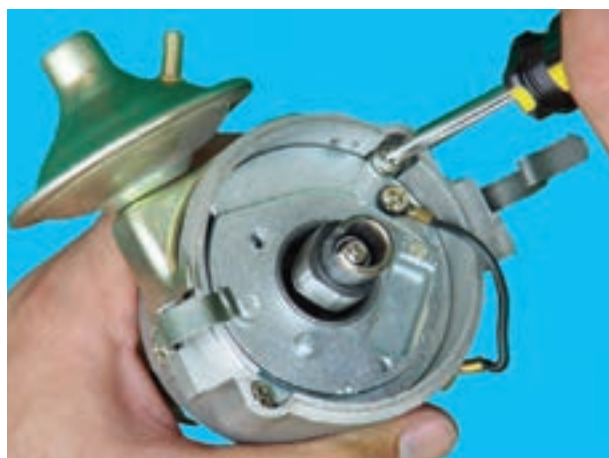
شکل ۱۹-۱۰- باز کردن پیچ‌های صفحه‌ی دلکو
