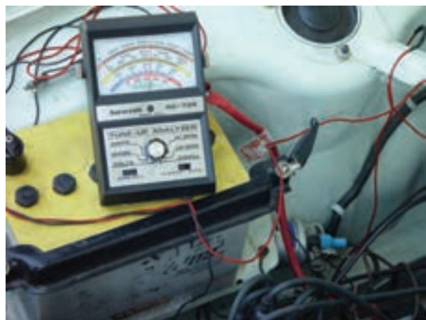
شکل ۱۰-۱۳- مقادیر زاویه‌ی نشست پلاتین (دول)
