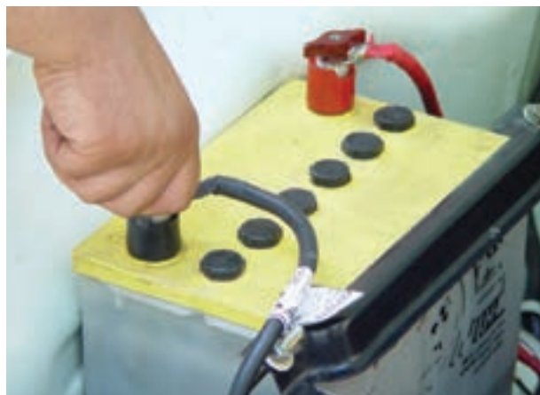
شکل ۱-۴۹- باز کردن اتصال بدنه باتری
