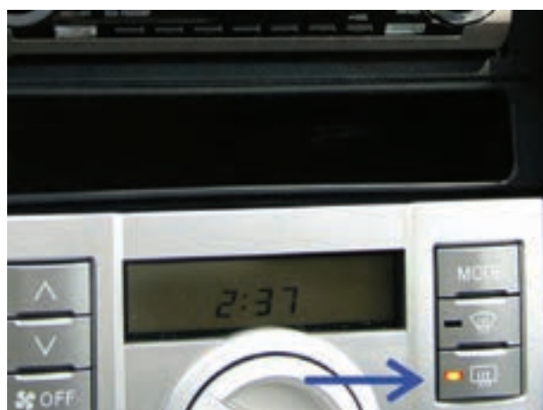
شکل ۳-۱۷- سوئیچ شیشه گرم‌کن در حالت (on)
