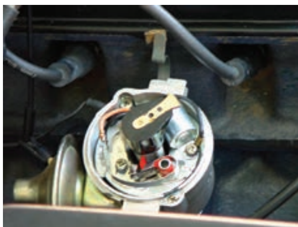
شکل ۵۵-۱۰- راستای چکش برق به سمت سیلندر یک
