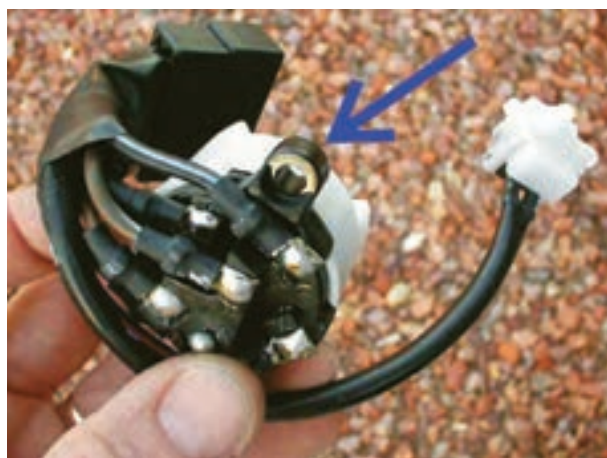
شکل ۷-۱۱- فیبری سوئیچ یک نوع خودرو
