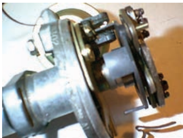
شکل ۱۰-۷۳- دلقوی الکترونیکی با حسگر اثرهال
