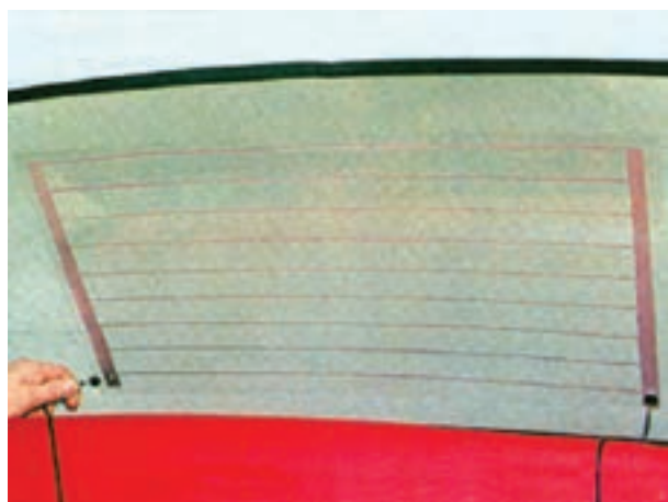
شکل ۳-۱۰- برقراری اتصالات الکتریکی
