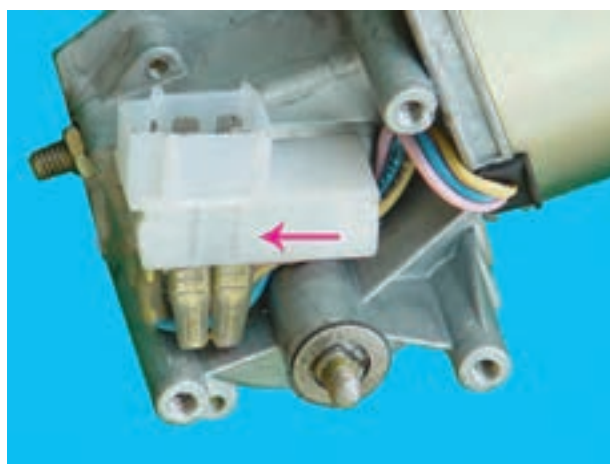
الف) ترمینال موتور و جهت جدا کردن آن
