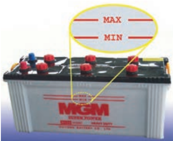
شکل ۱-۲۶ - علامت‌های سطح مجاز حداقل و حداکثر الکترولیت در روی جعبه‌ی باتری
