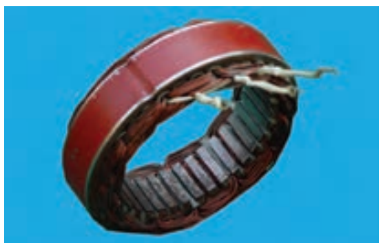
شکل ۷-۳۷- استاتور با سربپیچ های خروجی
