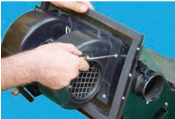
شکل ۴-۳۶ – باز کردن پیچ‌های محافظه‌ی موتور
