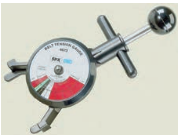
شکل ۸۸-۷- دستگاه اندازه‌گیر کشش تسمه
