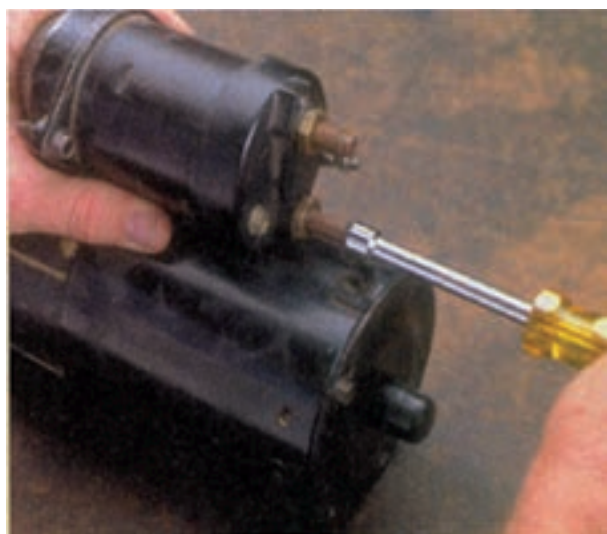
شکل ۸-۵۲ - باز کردن پیچ‌های اتصال اتومات به استارت
