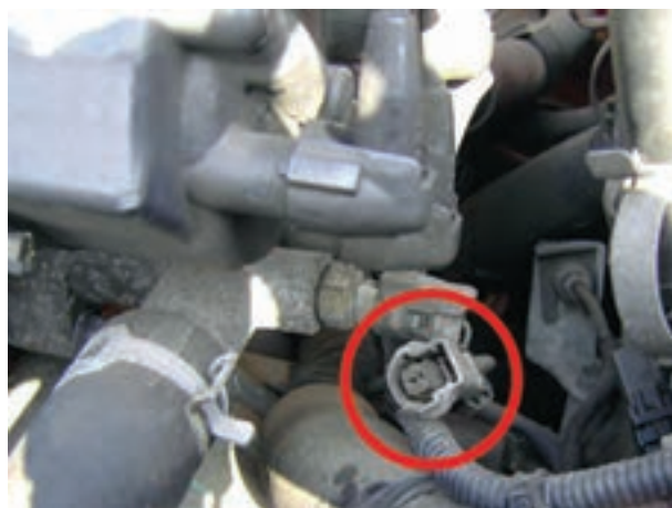
شکل ۱۶-۶- جدا کردن سوکت اتصال
