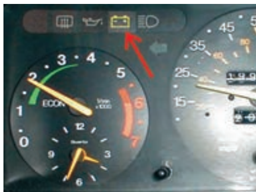
شکل ۱۰-۳ لامپ شارژ یک نوع خودرو
