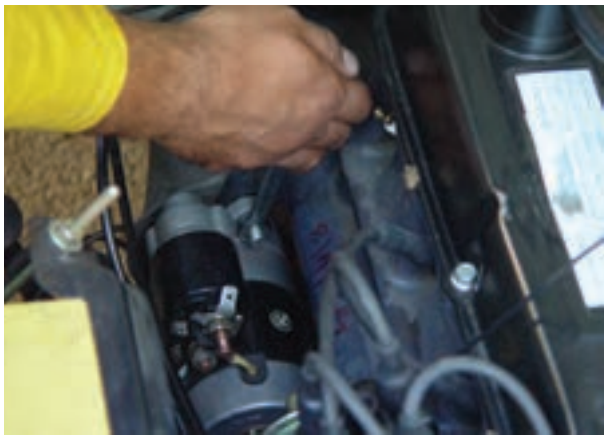
الف- باز کردن پیچ‌های استارتر
