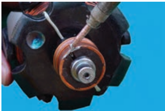
شکل ۶۶-۷ – جدا کردن سیم‌های روتور از کلکتور
