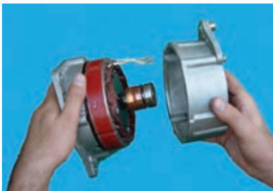
شکل ۶۱-۷ - جدا کردن درپوش‌های آلترناتور
