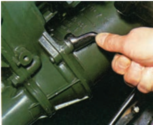
شکل ۸-۷۶ - بستن استارتر روی موتور
