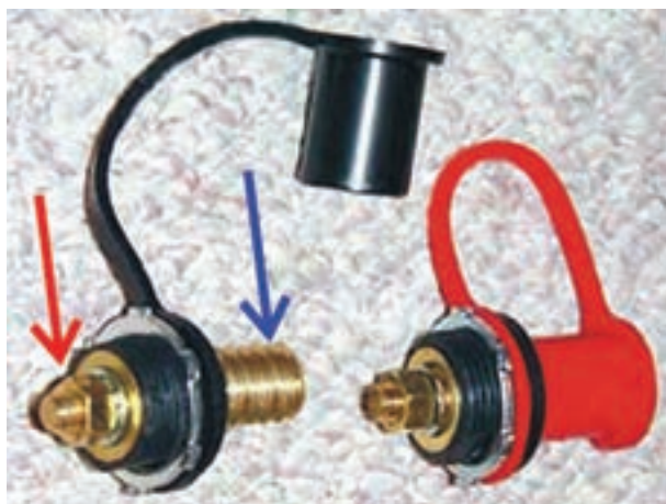
شکل ۱۴-۲- واسطه‌ی اتصال ترمینال باتری
