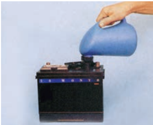
شکل ۱-۲۷ - پر کردن خانه‌های باتری نو با الکترولیت
