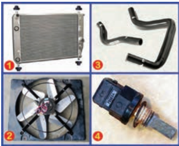
شکل ۲-۶- اجزای مدار خنک کاری
