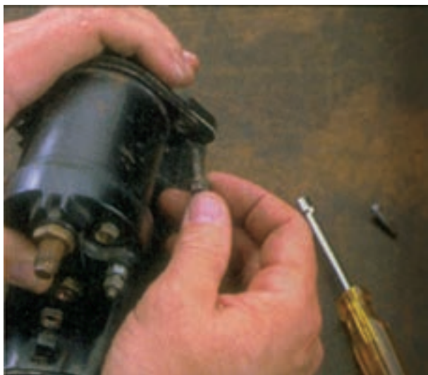
شکل ۸-۵۳ - بیرون آوردن پیچ‌های اتومات
