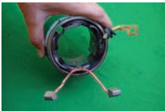
ب - زغال مثبت و محل لحیم آن شکل ۲۲-۸ - زغال یا جاروبک استارت
