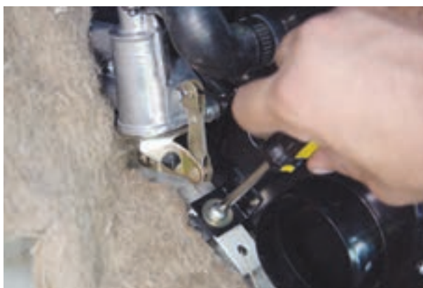
شکل ۴-۳۳- پیچ‌های پایه‌ی بخاری
