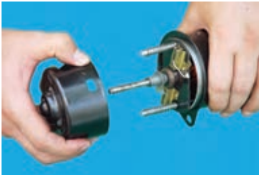
شکل ۴۵-۴ جدا کردن پوسته‌ی موتور
