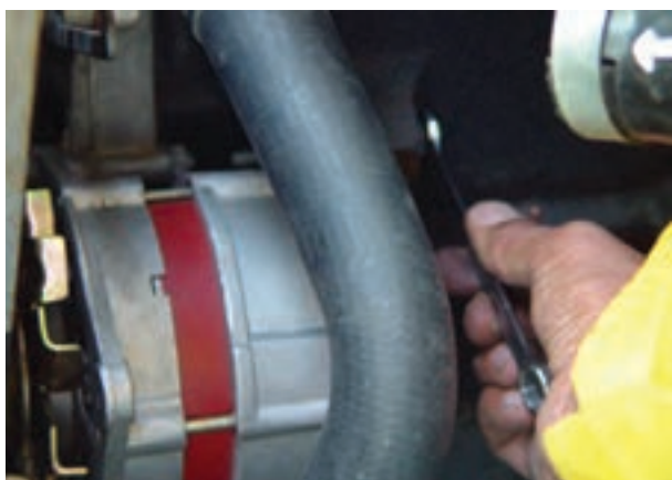
الف - بازکردن پیچ‌های پایه‌ی آلترناتور
