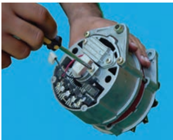
شکل ۷-۵۳- بازکردن پارازیت گیر
