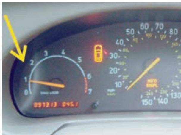
شکل ۷-۱۰۰- حالت دور آرام موتور
