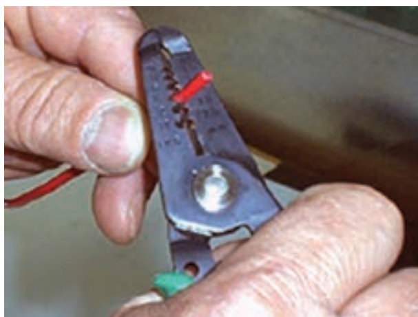
شکل ۳-۳۸- جدا کردن عایق سر سیم ها
