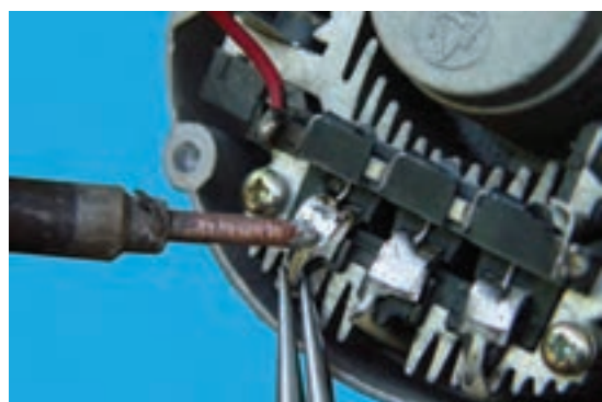
شکل ۷-۵۶- جدا کردن سیم‌های استاتور از یک‌سوکننده
