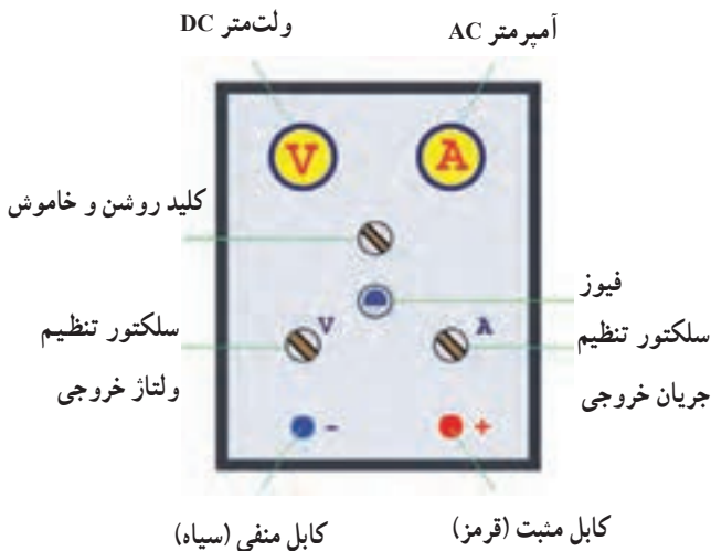
شکل ۴۶-۱- اجزای دستگاه شارژ باتری
