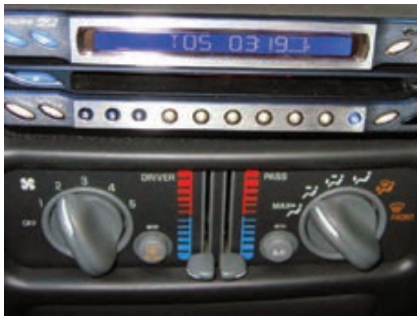
شکل ۲۳-۵- سوئیچ راه‌انداز فن کولر
