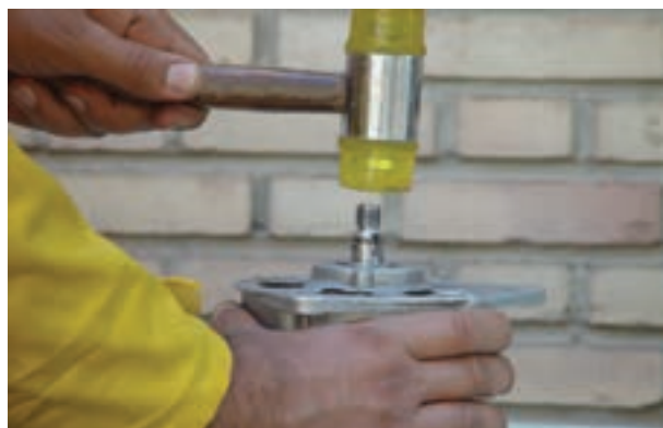
شکل ۶۳-۷ - بیرون آوردن روتور از درپوش
