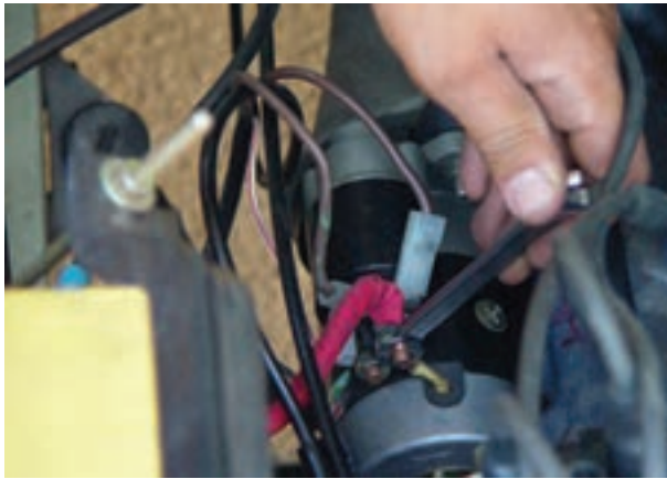
شکل ۸-۴۸- جدا کردن اتصالات الکتریکی استارت
