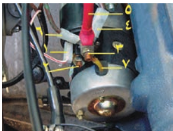
شکل ۲۰-۲- ترمینال‌های اتوماتیک استارتر
