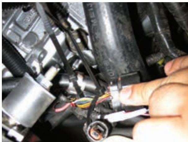
شکل ۴۵-۵ بررسی اتصالات الکتریکی سیم‌کشی
