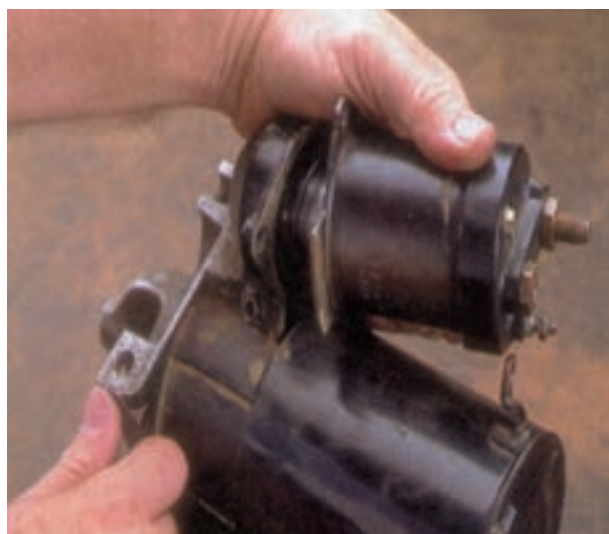
شکل ۸-۵۴ - خارج کردن اتومات
