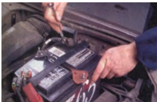
شکل ۱-۹۵- اتصال کابل‌های مثبت و منفی باتری
