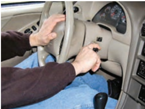
شکل ۴۵-۷- روشن کردن موتور
