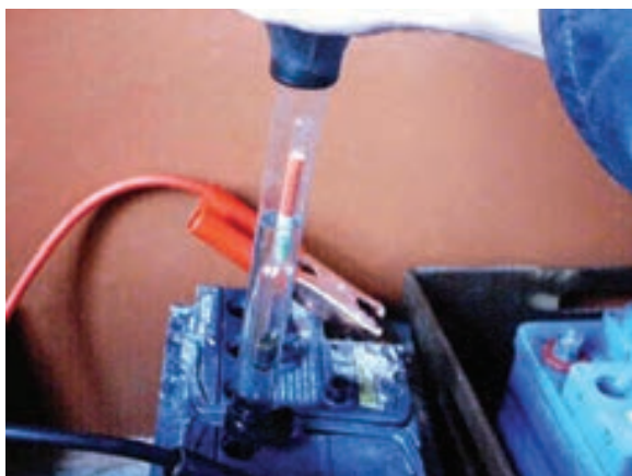
شکل ۱-۶۲- کنترل غلظت الکترولیت
