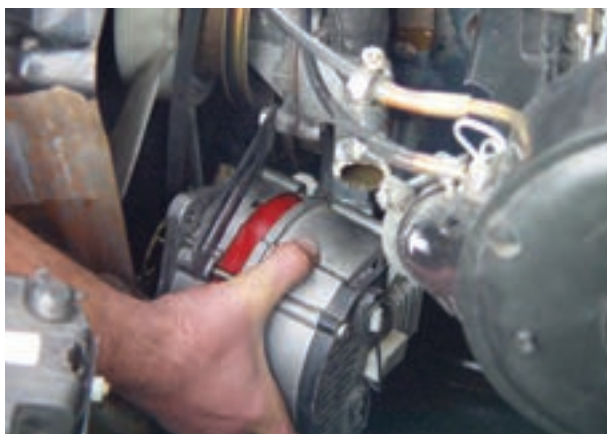
ب - بیرون آوردن آلترناتور از موتور شکل ۵۱-۶
