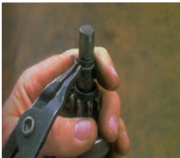
شکل ۸-۶۱ – درآوردن خار رینگی
