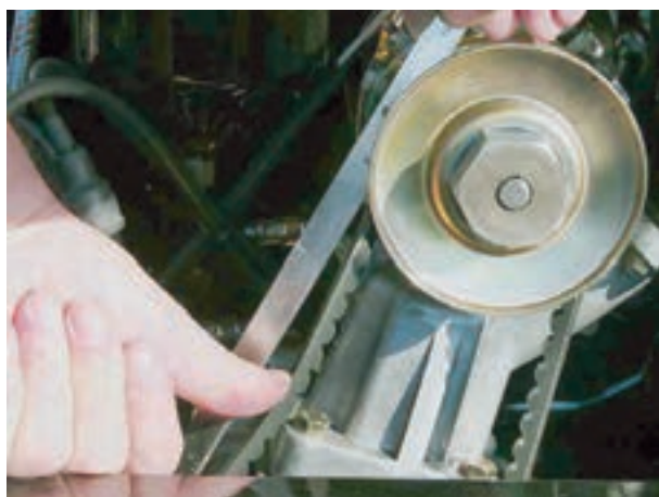
شکل ۸۹-۷- اندازه‌گیری خلاصی تسمه پروانه
