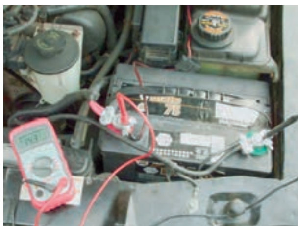
شکل ۷-۱۰۲- اندازه‌گیری ولتاژ شارژ
