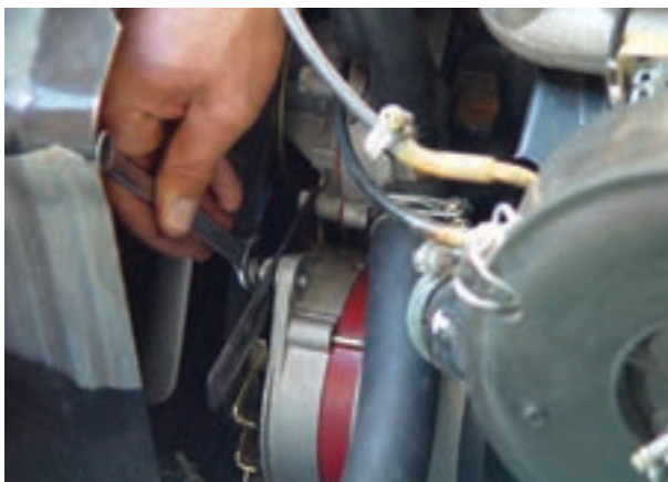
شکل ۷-۴۹ - باز کردن پیچ‌کنش تسمه پروانه
