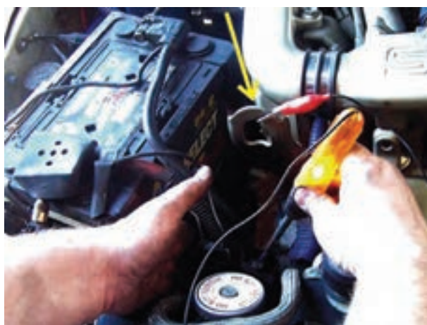
شکل ۴۳-۵- نحوه ی آزمایش سالم بودن سیم کشی
