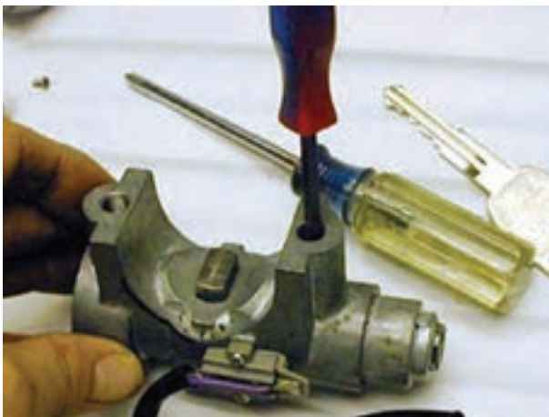
شکل ۱۱-۱۸- باز کردن پیچ مغزی سوئیچ
