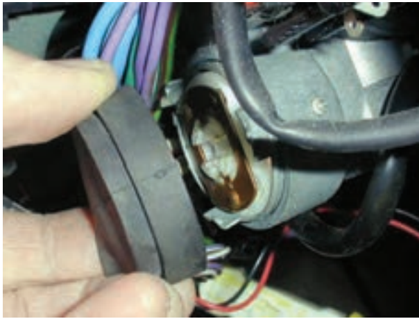
شکل ۱۱-۱۳- بیرون آوردن فیبری پشت سوئیچ
