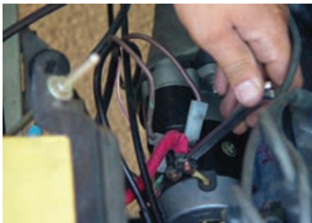
شکل ۸-۴۸- جدا کردن اتصالات الکتریکی استارت
