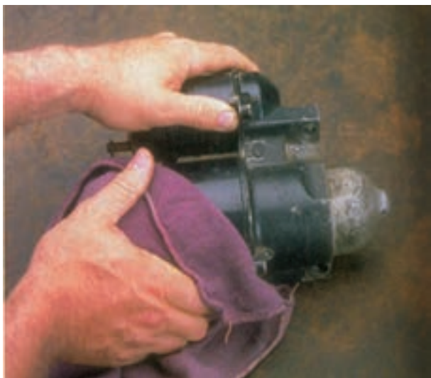
شکل ۸-۵۰ - تمیز کردن استارت
