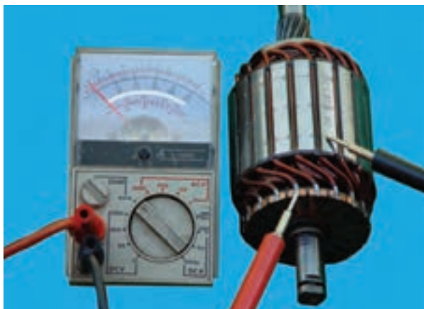
شکل ۸-۶۷- آزمایش اتصال کوتاه شدن آرمیچر
