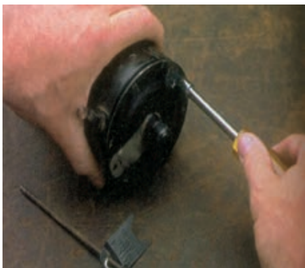
شکل ۸-۵۵ - باز کردن پیچ‌های اتصال درپوش به بدنه
