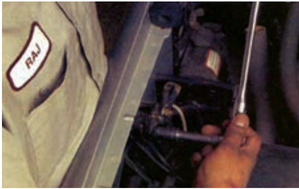
شکل ۸-۴۵ - اندازه‌گیری افت ولتاژ رله‌ی استارتر
