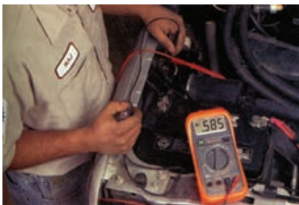
شکل ۸-۴۴- اندازه‌گیری افت ولتاژ پلاتین‌های سولونویید استارتر
