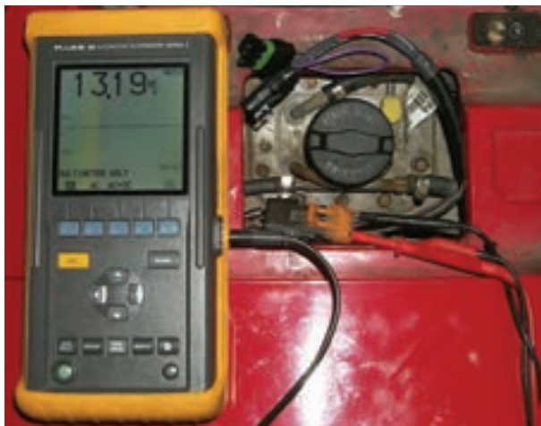
شکل ۴۶-۸ اندازه گیری ولتاژ مدار
