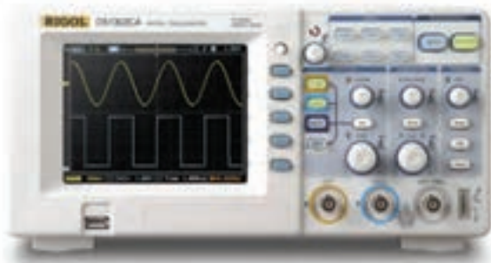
شکل ۱۳۲-۲. اسیلوسکوپ دو کاناله‌ی دیجیتالی. اسیلوسکوپ دو کاناله می‌تواند و شکل موج را به‌طور هم‌زمان روی نمایش‌گر نشان دهد.
