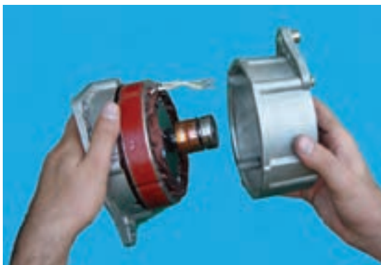
شکل ۶۱-۷ - جدا کردن درپوش‌های آلترناتور
