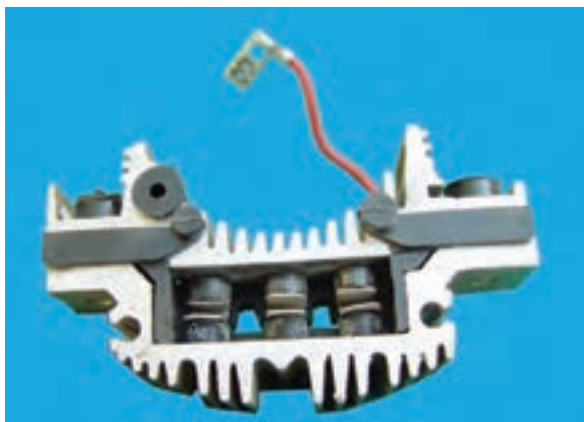
شکل ۴۲-۷ - مجموعه‌ی یک سوکننده
