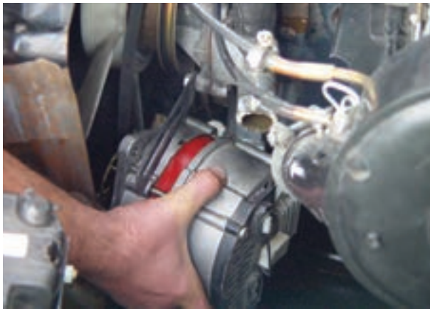
ب - بیرون آوردن آلترناتور از موتور شکل ۵۱-۶
