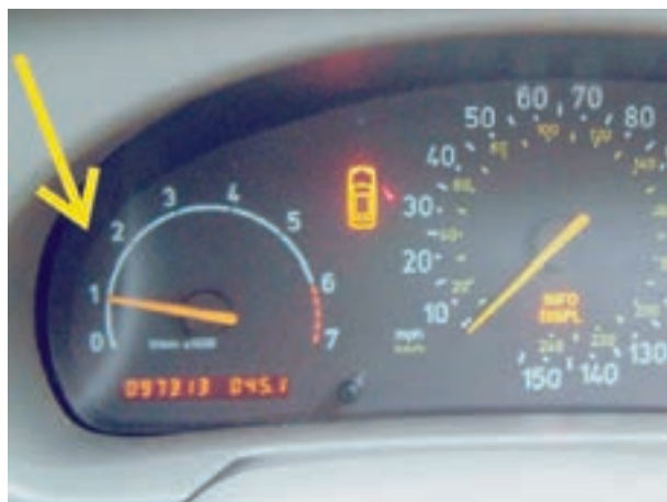
شکل ۷-۱۰۰- حالت دور آرام موتور
