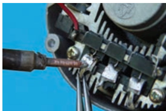
شکل ۷-۵۶- جدا کردن سیم‌های استاتور از یک‌سوکننده
