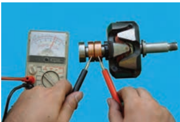
شکل ۷۵-۷- آزمایش سالم بودن سیم پیچ روتور
