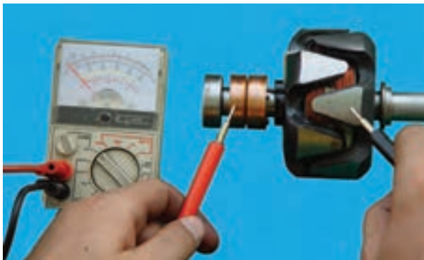
شکل ۷۴-۷- آزمایش اتصال بدنه نبودن سیم پیچ روتور
