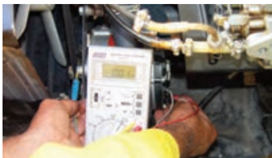
شکل ۷-۷۲ - اتصال ولت‌متر بین ترمینال B و بدنه
