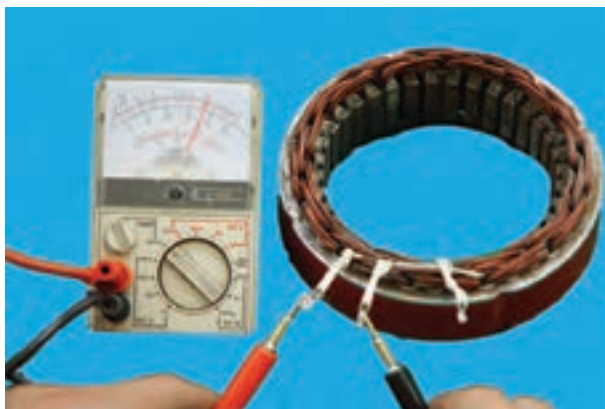
شکل ۷۹-۷- آزمایش سالم بودن سیم پیچ استاتور
