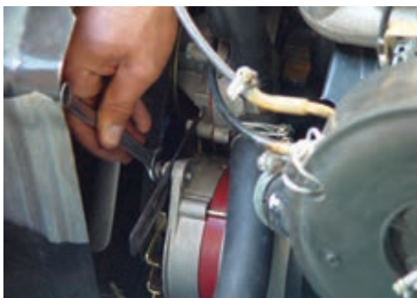
شکل ۷-۴۹ - باز کردن پیچ کشش تسمه پروانه
