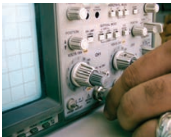
شکل ۱۱۴-۲ نحوه‌ی اتصال BNC به اسیلوسکوپ
