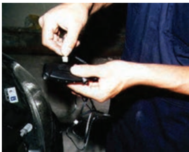
الف – اتصال سوکت سیم‌کشی به چشمی الکترونیک
