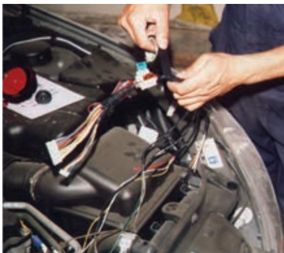
شکل ۲-۷۷ - نحوه‌ی عایق‌بندی سیم‌های مدار الکتریکی دزدگیر
