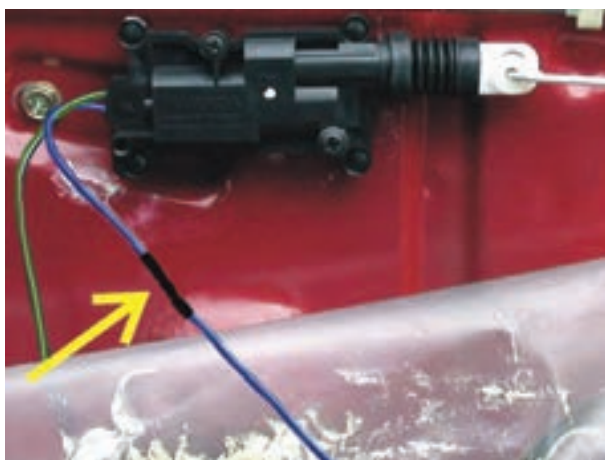
شکل ۴۹-۲- عایق کاری محل اتصال سیم‌ها به یکدیگر
