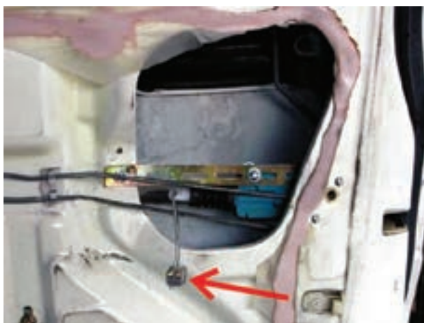
شکل ۲-۳۸- باز کردن بست فلزی از روی میله‌ی قفل کن دستی
