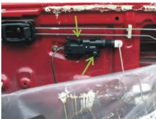
شکل ۲-۲۹ - اتصال عملگر الکتریکی در روی در خودرو
