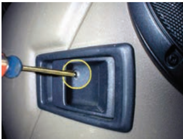
شکل ۲-۳۶- باز کردن قاب دستگیره‌ی قفل در
