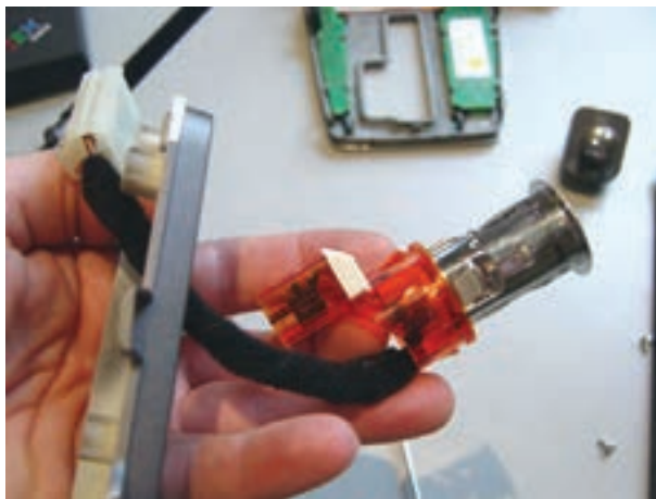
شکل ۲۳۴-۱- خارج کردن سیم و سوکت اتصال الکتریکی فندک از داخل قاب روی پانل
