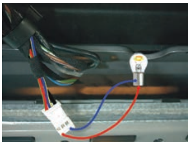
شکل ۱-۲۳۷- آزمایش سیم کشی مدار چراغ فندک
