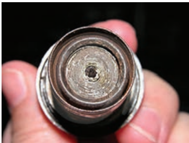
شکل ۱-۲۲۵- المنت حرارتی داخل سوئیچ فشاری
