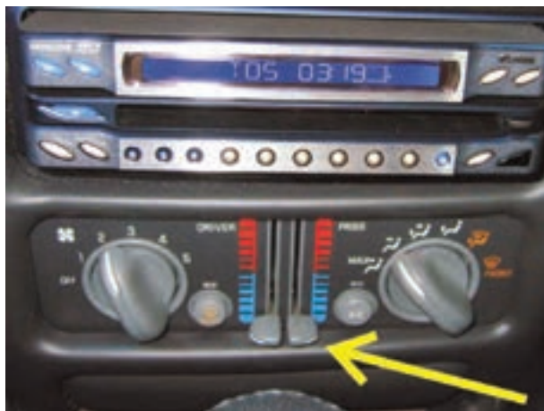
شکل ۴-۵۴- اهرم‌های تنظیم هوای ورودی
