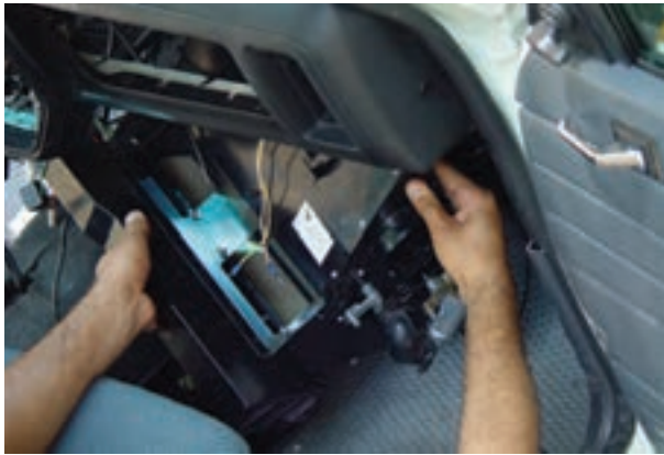
شکل ۳۴-۴- خارج کردن بخاری از محل نصب آب
