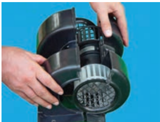
شکل ۴-۴۰- جدا کردن محفظه‌ی نگهدارنده‌ی موتور
