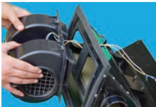
شکل ۴-۳۷- جدا کردن محفظه‌ی موتور از بخاری
