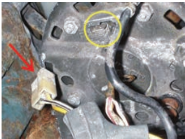
شکل ۳-۳۵- جدا کردن کاتوجویی سیم کنشی لامپ شارژ
