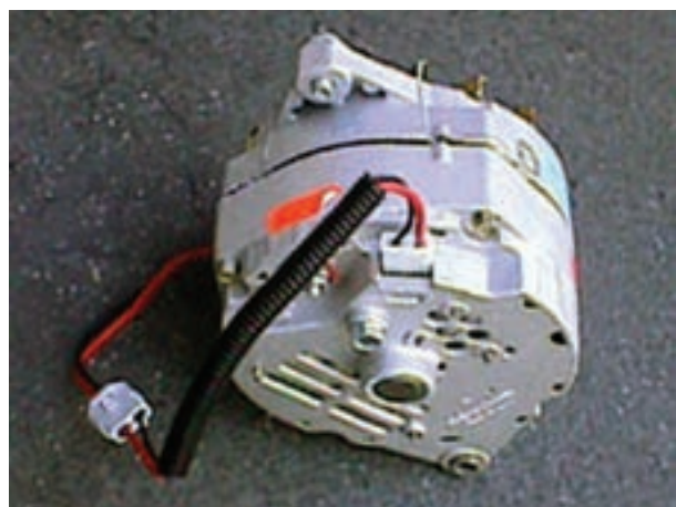
شکل ۳-۱۶- آلترناتور مجهز به آفتامات الکترونیکی
