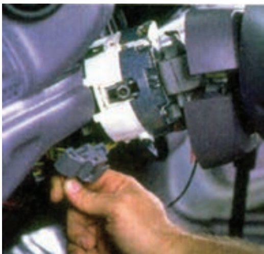
شکل ۹۴-۱- جدا کردن سوکت اتصال الکتریکی
