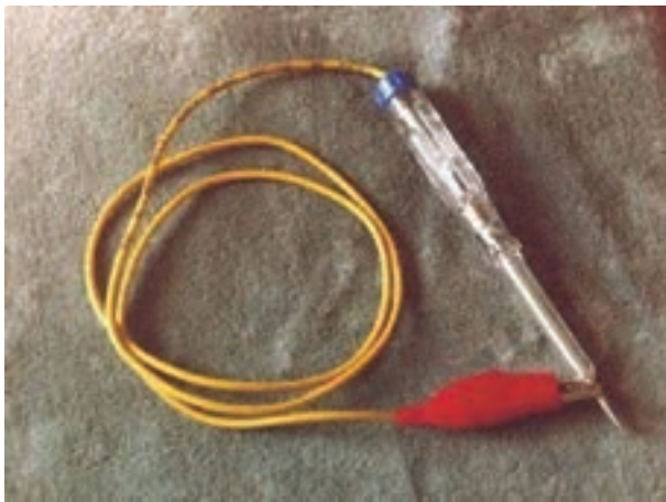
شکل ۱-۱۲۱- چراغ آزمایش بدون باتری
