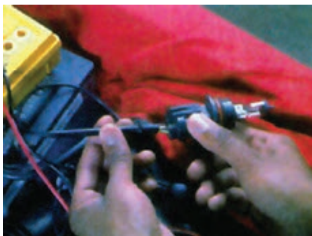
شکل ۱۴۲-۱- آزمایش لامپ چراغ‌های بزرگ جلو
