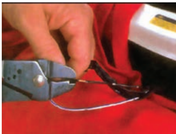
شکل ۱۴۶-۱- استفاده از انبر مخصوص برای قطع سیم
