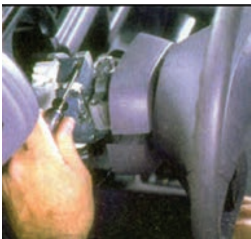
شکل ۹۵-۱- باز کردن پیچ بدنه ی سوئیچ روشنایی
