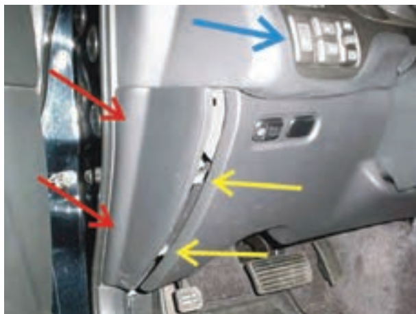
شکل ۱-۸۲- خارهای روی قاب و سوئیچ چراغ‌های بزرگ جلو
