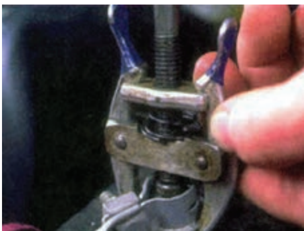
شکل ۱-۸۹- باز کردن بست اتصال بدنه‌ی باتری
