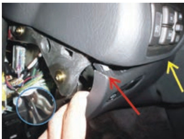
شکل ۱-۸۵- خارج کردن قاب از روی بدنه‌ی پانل
