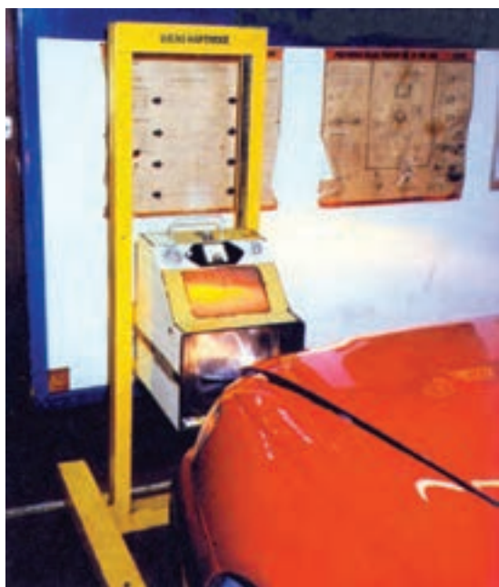
شکل ۱۵۳-۱- یک نوع دستگاه تنظیم نور چراغ‌های بزرگ
