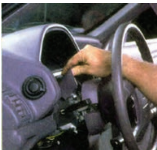
شکل ۹۱-۱- بیرون آوردن قاب سوئیچ روشنایی
