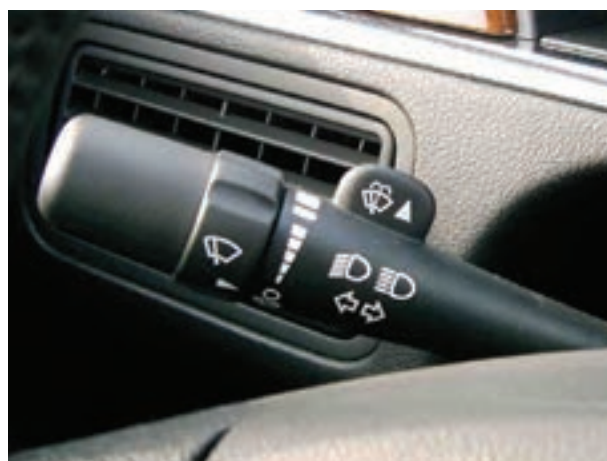
شکل ۲-۱۰- سوئیچ برف پاک کن تایمردار
