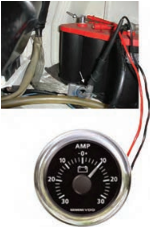
شکل ۱-۵۲ اتصال آمپر متر به صورت سری
