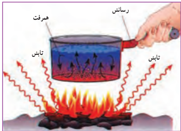
شکل ۳-۱۱- انتقال گرما به هر سه روش
