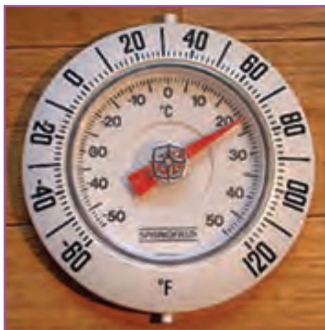
شکل ۳-۵ - دماسنج با دو مقیاس
