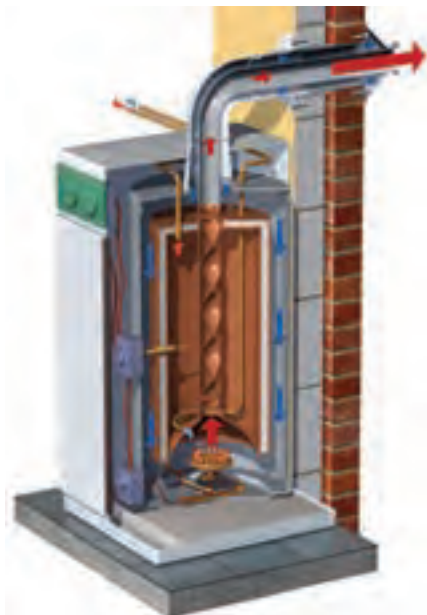
شکل ۳-۱۳- یک مبدل گاز به مایع (آب گرم کن زمینی)
