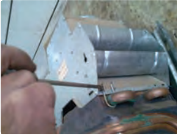
شکل ۶-۱- جدا کردن کلاهک تعدیل از مبدل
