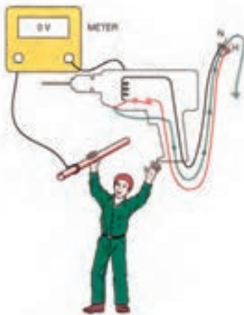
شکل ۴-۲۶ دستگاه دریل دارای سیم ارت
