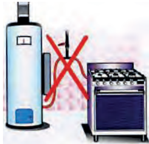
شکل ۳-۹ نصب نادرست آب گرم کن زمینی به جای آب گرم کن دیواری
