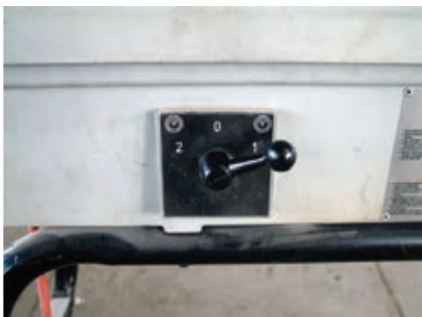
شکل ۴-۷۹- کلید خاموش و روشن کردن حدیده‌ی ماشینی
