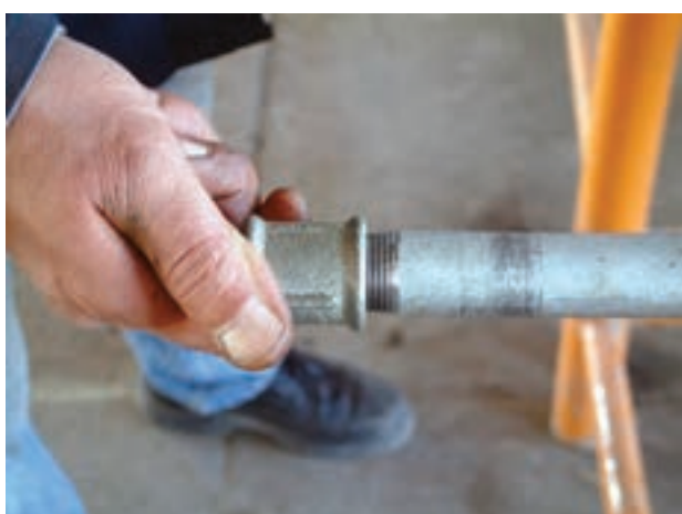
شکل ۴-۴۱- کنترل بار سردنده به وسیله‌ی یک فیتینگ
