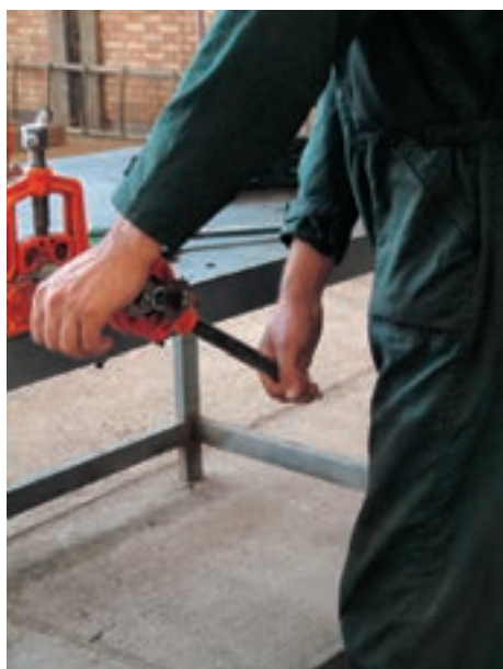
شكل ۴-۱۱۲- حديدكاهى متناسب با قطر لوله
