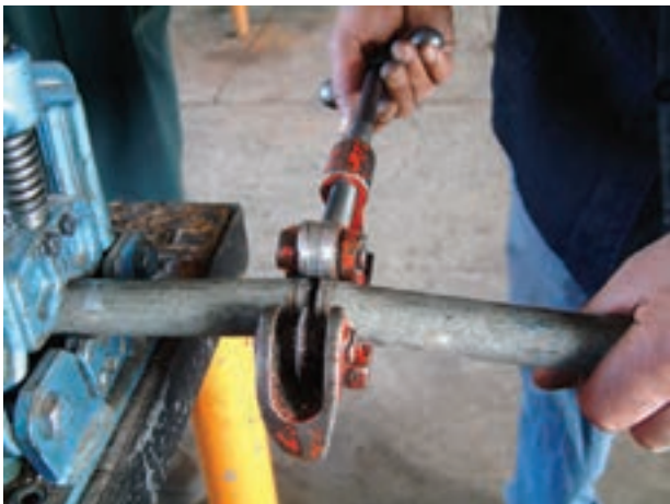
شکل ۱-۵۹- انتهای عمل بُرش‌کاری
