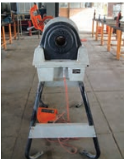
شکل ۴-۷۵- حديدى ماشينى سيّار نصب شده بر روى پايه
