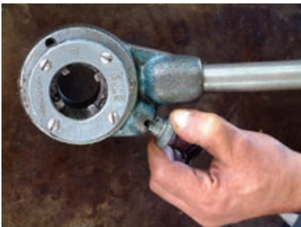
شکل ۴-۴۳- خارج کردن ضامن از شيار
