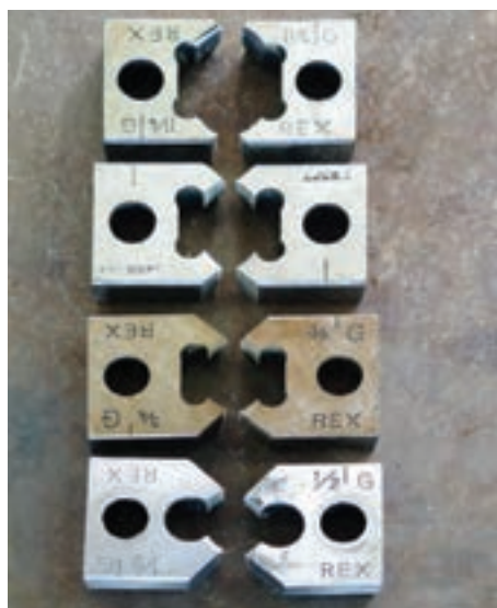
شکل ۴-۲۳- پارچه‌های حدیده‌ی دستی دو پارچه
