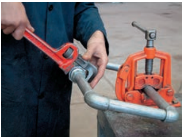
شکل ۵-۱۰۶- نحوه‌ی غلط سفت کردن مهره ماسوره
