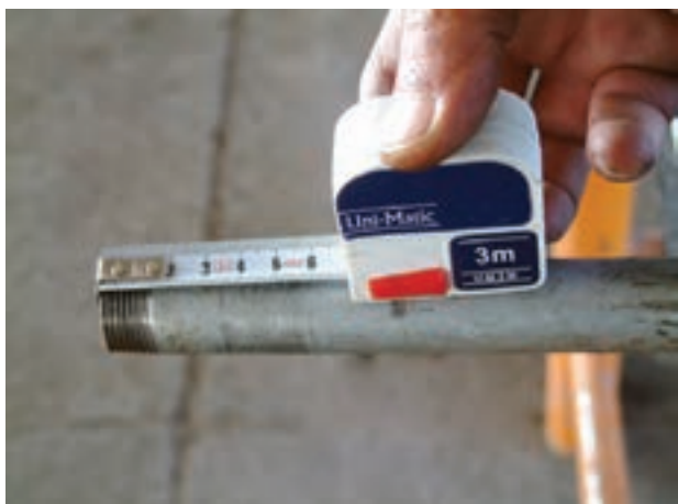
شکل ۱۲۸-۴ اندازه‌گیری لوله‌ی حدیده شده
