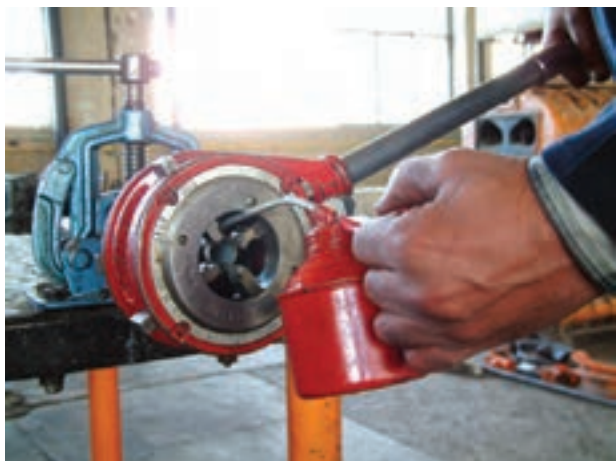
شکل ۱۲۳-۴ استفاده از روغن دان در جریان حديدكاري
