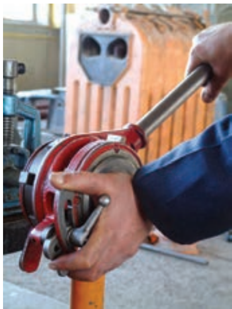
شکل ۴-۱۲۲- عمل درگیر کردن پارچه‌ها با سر لوله
