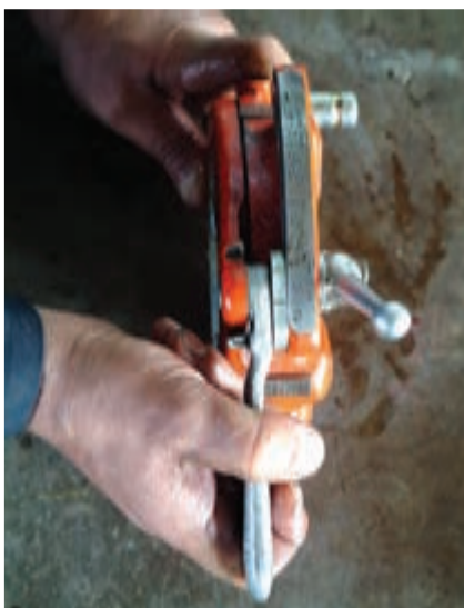
شکل ۴-۹۳- تنظیم حدیده به اندازه‌ی لوله‌ی ۲ اینچ
