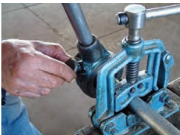
شکل ۴-۴۶- قرار دادن ضامن در جهت حدیده کردن
