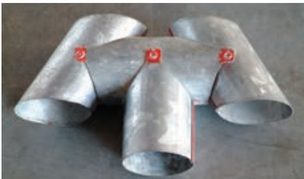
شکل ۴-۱- اتصال چند قطعه به روش پرچ‌کاری
