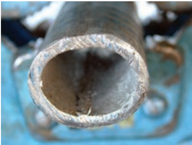
شکل ۱-۶۱- لوله‌ی دو پهن شده
