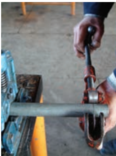
شکل ۴-۷۷- لوله بُر در حال گردش به دور لوله
