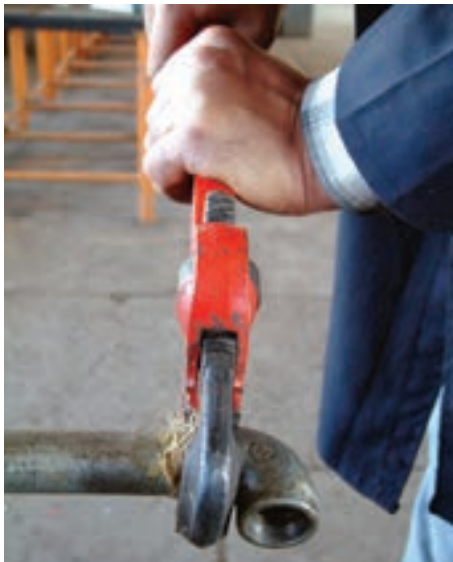
شکل ۵-۵۹- آچار لوله‌گیر
