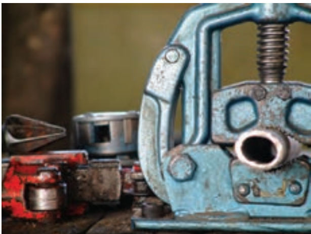
شکل ۲-۱۶- لوله‌ی دو پهن شده
