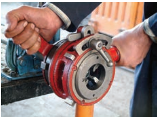
شکل ۴-۱۲۰- بستن اهرم فلک‌های چهار نظام
