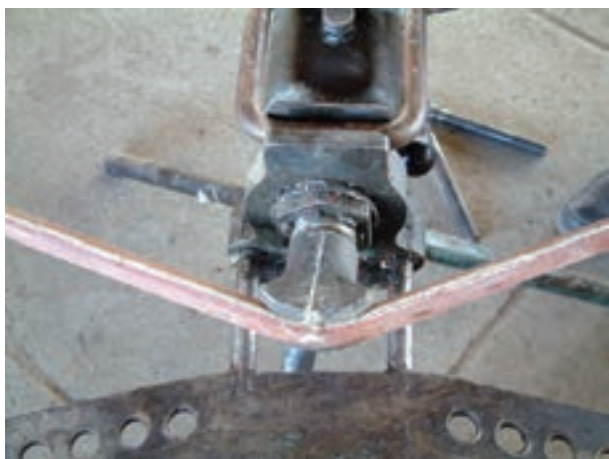
شکل ۳-۲۵- پایان عمل خم‌کاری
