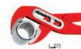
شکل ۵-۷۰- سوراخ‌ها و شیارهای متعدد آچارهای کلاغی
