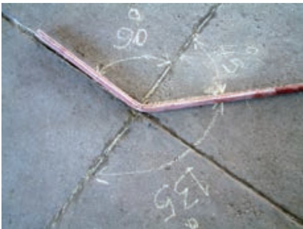
شکل ۲۹-۳ کنترل خم لوله‌های ۴۵ درجه
