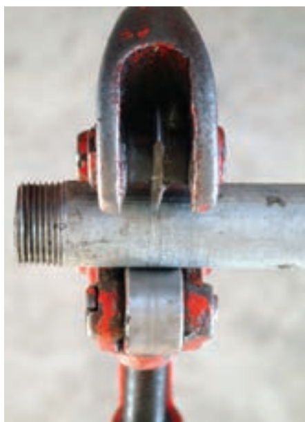
شکل ۵-۹۶- استفاده‌ی غلط از لوله‌بر با تیغه‌ی شکسته
