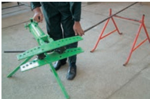
شکل ۳-۴۲- استفاده از خرک در خم‌کاری
