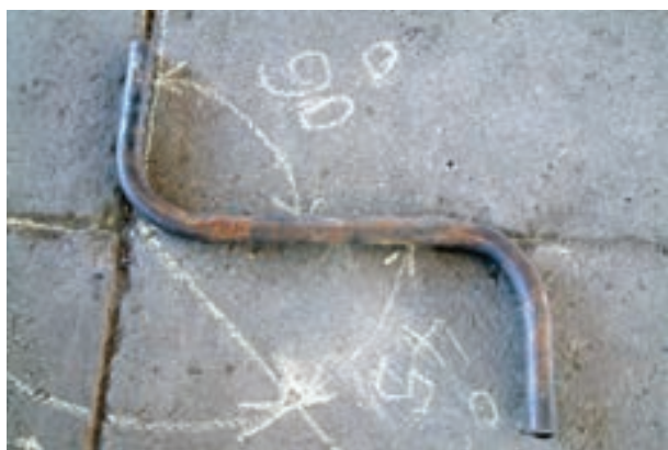
شکل ۳-۴۱- عدم دویدگی لوله‌ی دو خم
