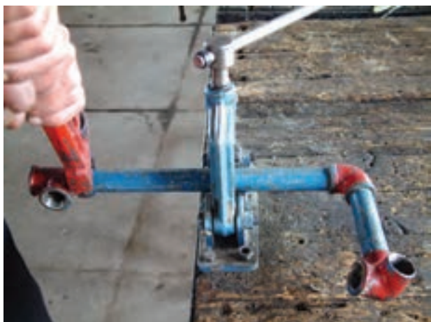
شکل ۵-۱۵۵- بستن سهراهی به ضلع دوم مدار
