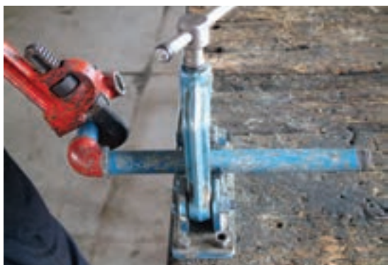
شکل ۱۵۴-۵- بستن لوله‌ی ضلع دوم مدار
