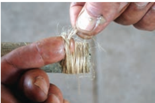
شکل ۵-۵۵- گره زدن انتهای پیچیدن کنف
