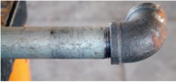
شکل ۹۹-۵- سفت کردن مناسب فیتینگ به لوله
