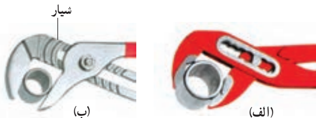
شکل ۷۰-۵- سوراخ‌ها و شیارهای متعدد آچارهای کلاغی
