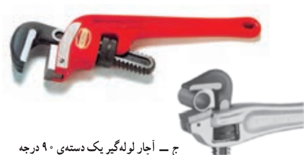
شکل ۵-۶۳- انواع آچار لوله‌گیر یک دسته
