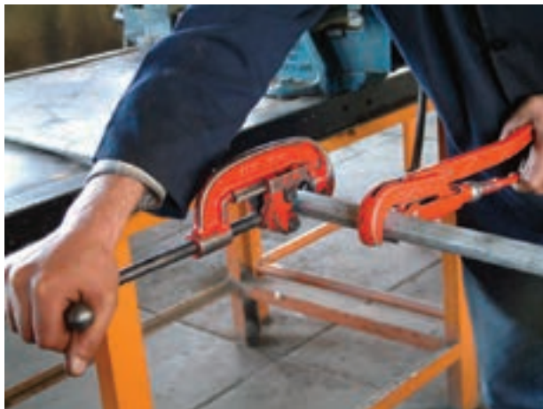
شکل ۱۱۶-۵- ادامه‌ی برش‌کاری لوله
