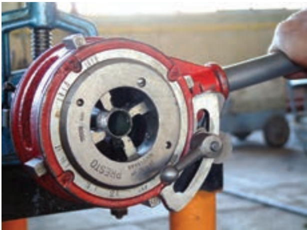
شکل ۱۲۴-۴- عمل حديدك كاري تا عبور پارچه‌ها از لبه‌ي لوله
