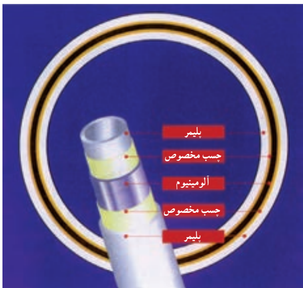
شکل ۲۰-۵- ساختار لوله‌ی پلی اتیلن پنج لایه
