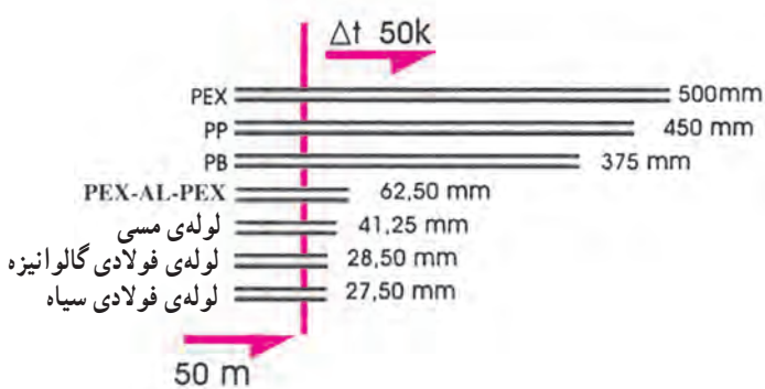
شکل ۲۱-۵- مقایسه‌ی انبساط طولی پلیمرها و فلزات
