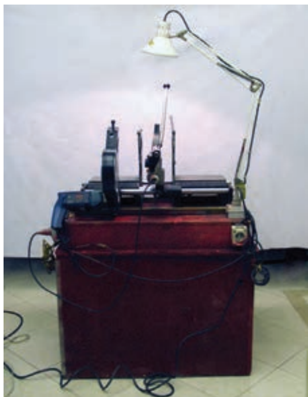
شکل ۲-۳۷- دستگاه جوش لوله و فیتینگ پلی اتیلن
