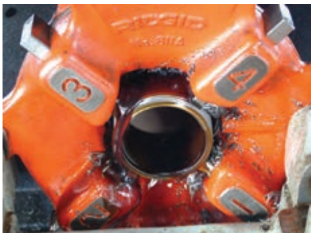
شکل ۴-۸۲- استفاده از روغن در موقع حدیده‌کاری
