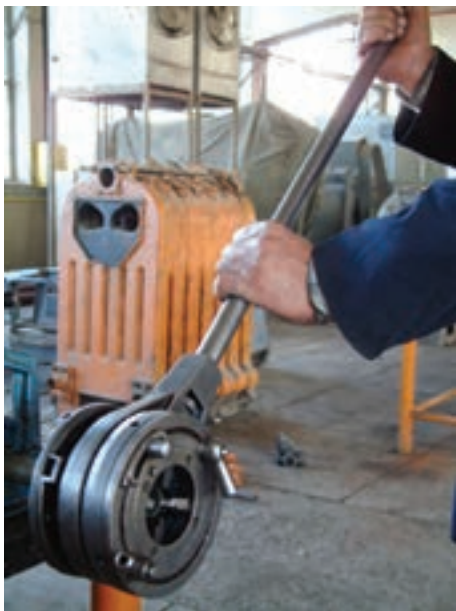
شکل ۴-۷۰- چرخاندن حدیدیه در جهت باز شدن پارچه‌ها از سر دنده
