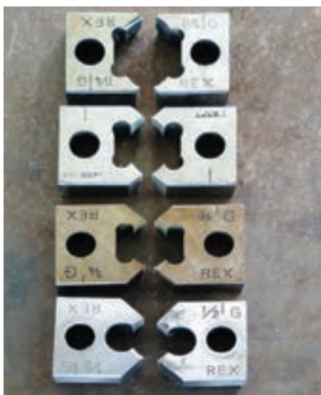
شکل ۴-۲۳- پارچه‌های حدیده‌ی دستی دو پارچه
