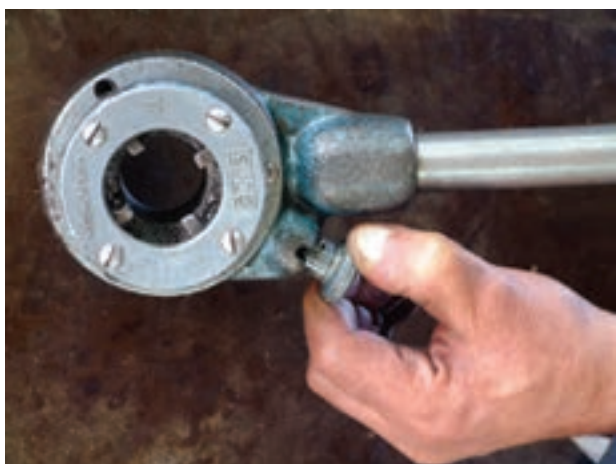
شکل ۴-۴۳- خارج کردن ضامن از شیار
