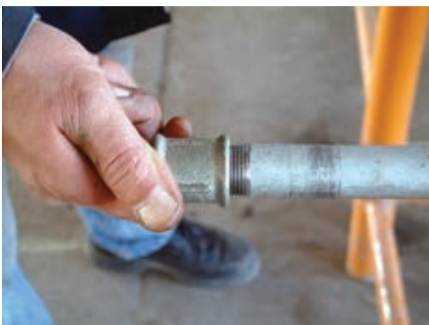
شکل ۴-۴۱- کنترل بار سردنده به وسیله‌ی یک فیتینگ
