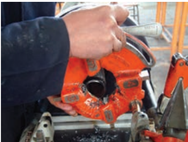
شکل ۴-۹۰- جدا کردن تنه‌ی حدیده از دستگاه
