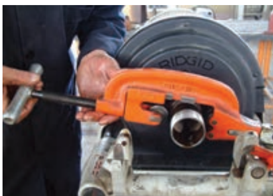
شکل ۴-۱۰۱- بریدن لوله به وسیله‌ی لوله‌بُر
