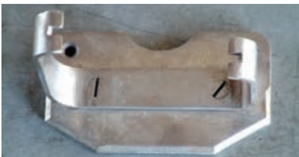
شکل ۴-۵ - اتصال موقت با استفاده از پیچ
