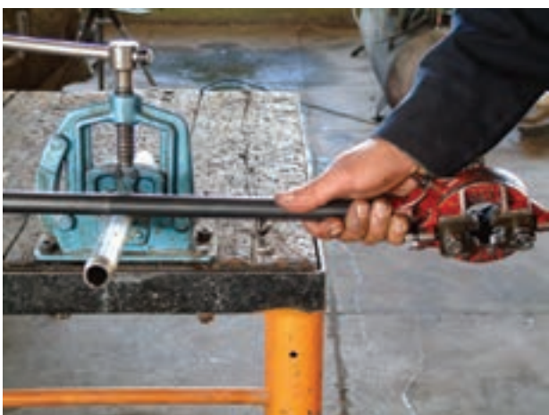
شکل ۴-۴۰- جدا کردن پلیسه‌ها از سردنده
