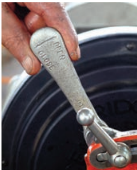
شکل ۴-۹۷- کشیدن ضامن تنظیم به عقب
