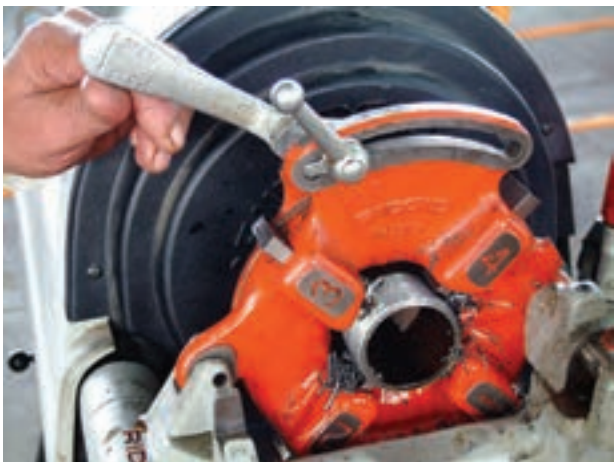
شکل ۴-۷۸- عمل حدیده‌کاری با حدیده‌ی ماشینی
