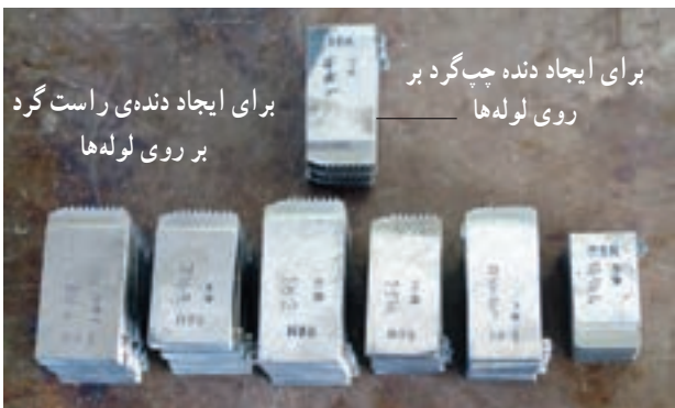
الف - چند دست پارچهي حديد، حديد‌هاي چهارپارچه
