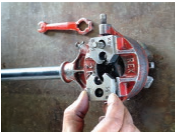
شکل ۴-۲۶- قرار دادن پارچه‌ها در محل خود
