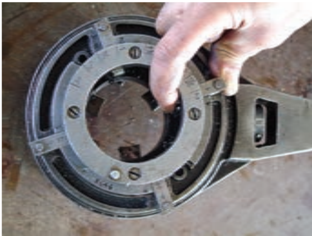
شکل ۴-۶۰- قرار دادن پارچه‌های مناسب در حدیده
