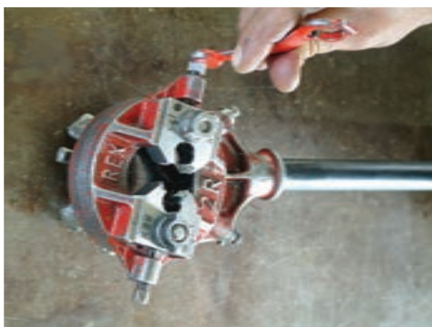
شکل ۲۰-۴- اجزای حدیده‌ی دستی دو پارچه
