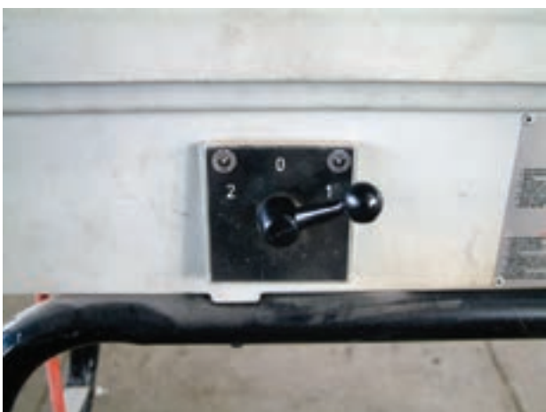
شکل ۴-۷۹- کلید خاموش و روشن کردن حدیده‌ی ماشینی
