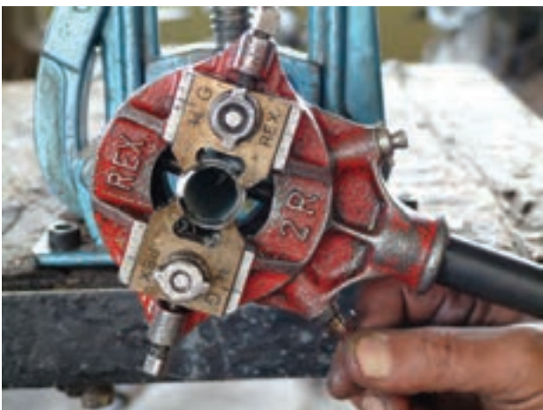
شکل ۴-۳۲- قرار دادن نوک تیز ضامن‌ها به سمت پایین
