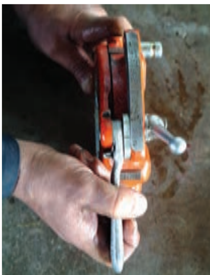
شکل ۴-۹۳- تنظیم حدیده به اندازه‌ی لوله‌ی ۲ اینچ
