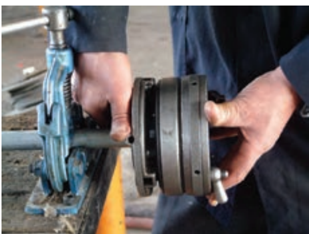
شکل ۴-۶۴- سفت کردن سه نظام حدیده
