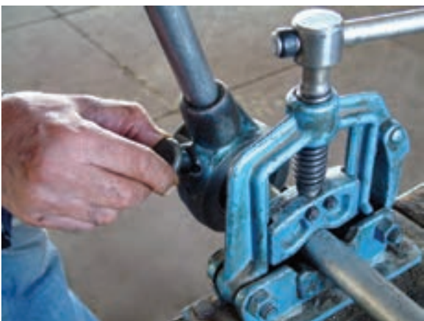
شکل ۴-۴۶- قرار دادن ضامن در جهت حدیده کردن
