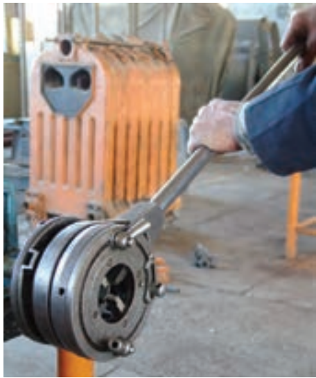
شکل ۴-۶۷- دنده کردن لوله
