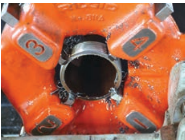
شکل ۴-۸۰- لوله در حال باز شدن از پارچه‌ها
