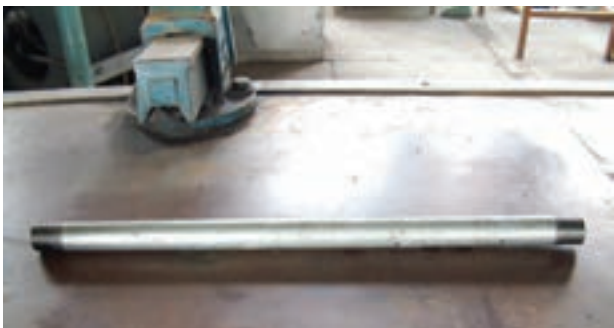
شکل ۴-۶ - لوله‌ی دو سر دنده شده
