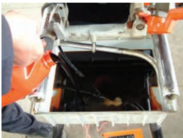
شکل ۴-۸۳- مخزن روغن حدیده‌ی ماشینی
