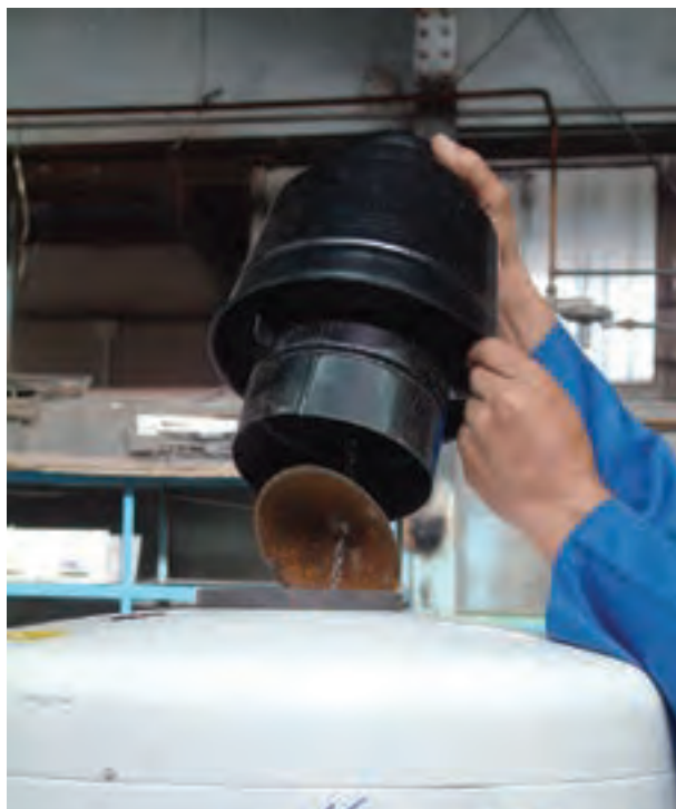
شکل ۱۱۵-۱- برداشتن کلاهک تعدیل از روی دودکش
