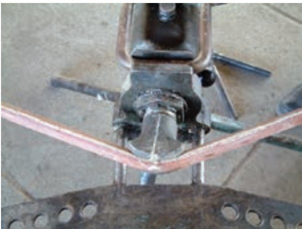
شکل ۳-۲۵- پایان عمل خم کاری
