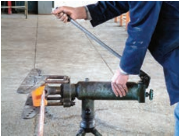
شکل ۱۱-۳- شروع خم کاری
