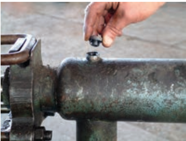
شکل ۱۵-۳- سرپوش مجرای ورودی روغن
