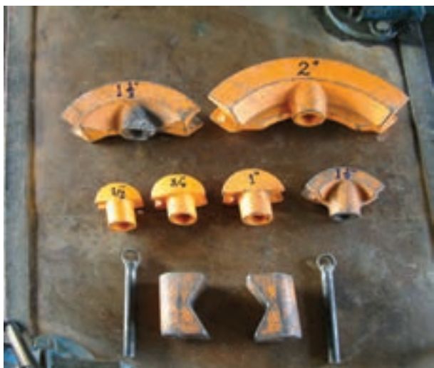
شکل ۳-۲۰ پارچه‌ها و لقمه‌های خم‌کن هیدرولیکی
