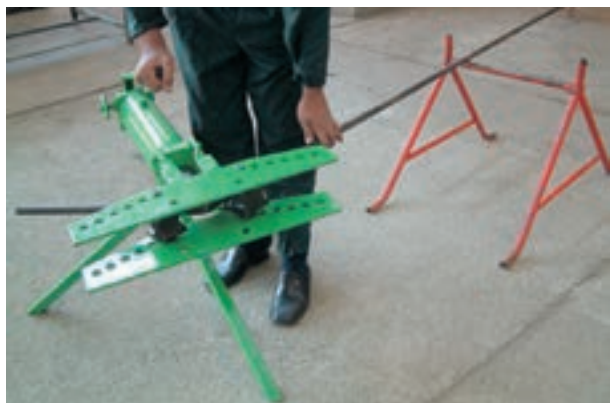
شکل ۳-۴۲- استفاده از خرک در خم کاری
