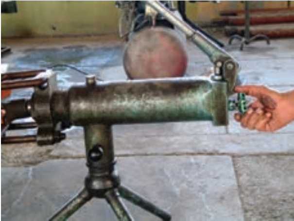
شکل ۳-۲۳- بستن شیر قطع و وصل
