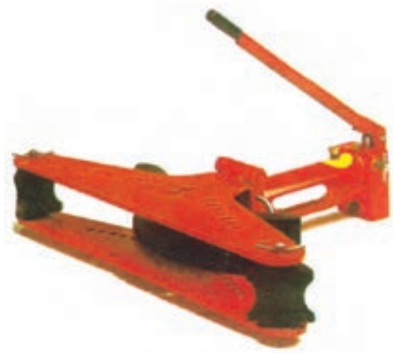
شکل ۱۰-۳- خم کن هیدرولیکی
