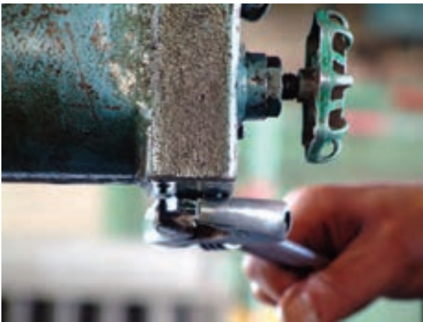
شکل ۱۴-۳- باز کردن درپوش تخلیه‌ی روغن
