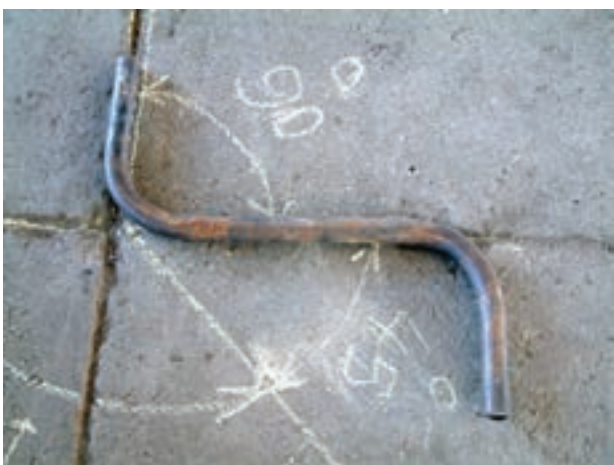
شکل ۵۸-۳- ادامه ی عمل خم کاری
