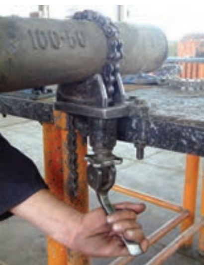
شکل ۱-۳۳- کشیدن اهرم قفل‌کننده
