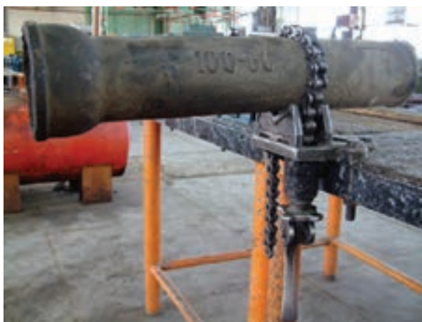
شکل ۱-۳۴- بستن لوله به گیره‌ی زنجیری
