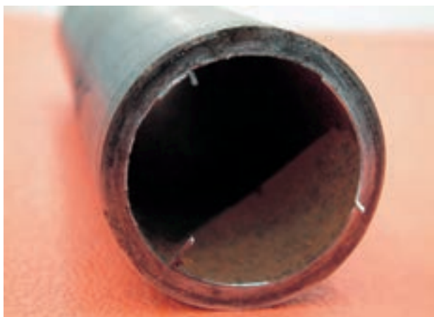
الف - لوله‌ی بریده شده به وسیله‌ی لوله‌بر
