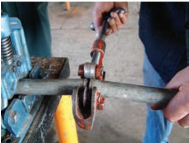
شکل ۱-۵۹- انتهای عمل بُرش‌کاری
