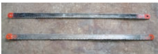
شکل ۱-۴۰ - از بین رفتن دندانهای تیغه اژه
