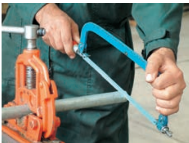
شکل ۵۰-۱- عدم رعایت فاصله‌ی مناسب از لب گیره
