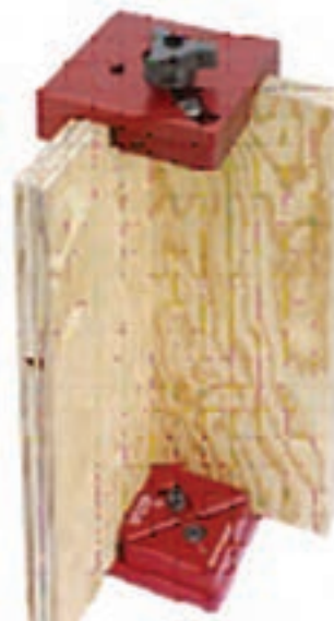
شکل ۳۶-۳ مونتاژ پانل های عمودی
