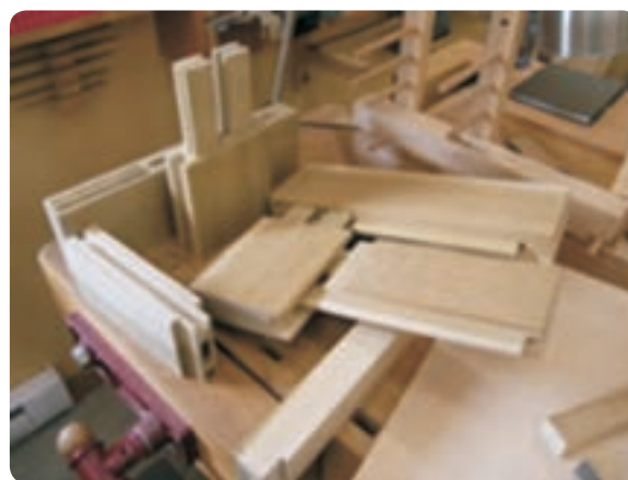
شکل ۴-۱ اتصالات مختلف در صنایع چوب
