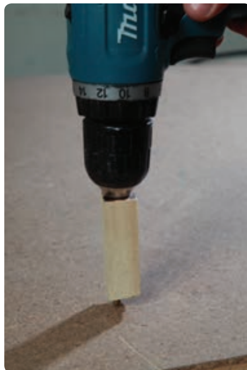
شکل ۳-۳۲ سوراخ دریل قطعه کنترل اندازه عمق
