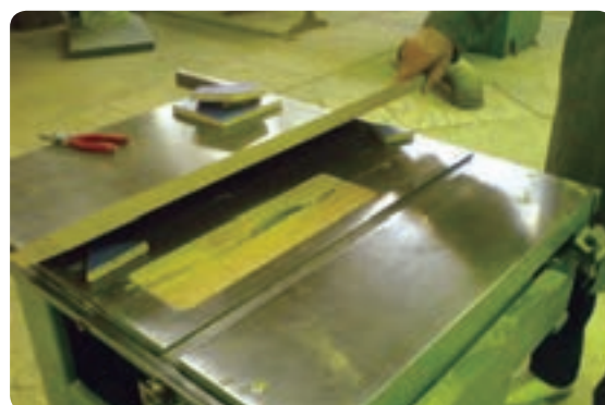
شکل ۳-۳۹ قراردادن دوعدد زیر سری برای ساخت گونیا
