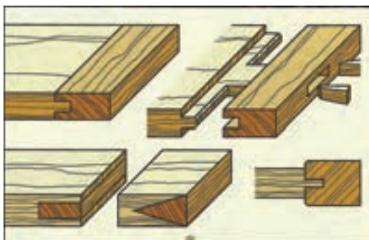
شکل (۵-۱۴) انواع اتصال قلیف با زبانه بلند با گونه زبانه سراسری
