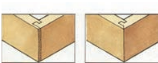
شکل (۵-۴۴) نیم و نیم دورو فارسی با دویل اتصال قلیف زبانه سرخود
