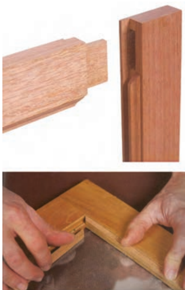
شکل (۵-۴۱) تصویر مجسم انفجاری اتصال گوشه قاب و اتصال آن
