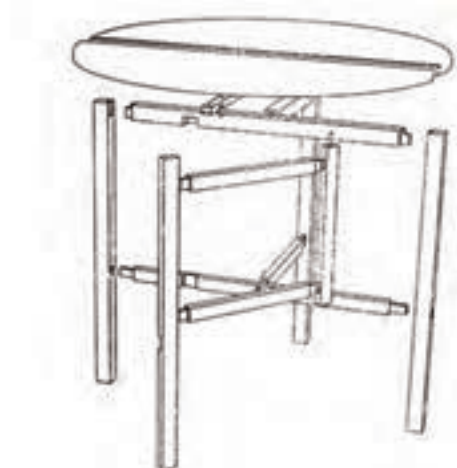
شکل (۲۴-۵) تصویر مجسم انفجاری میز با صفحه دو تکه کاربرد اتصالات گوشه‌ای کم و زبانه کوله‌دار و کم
