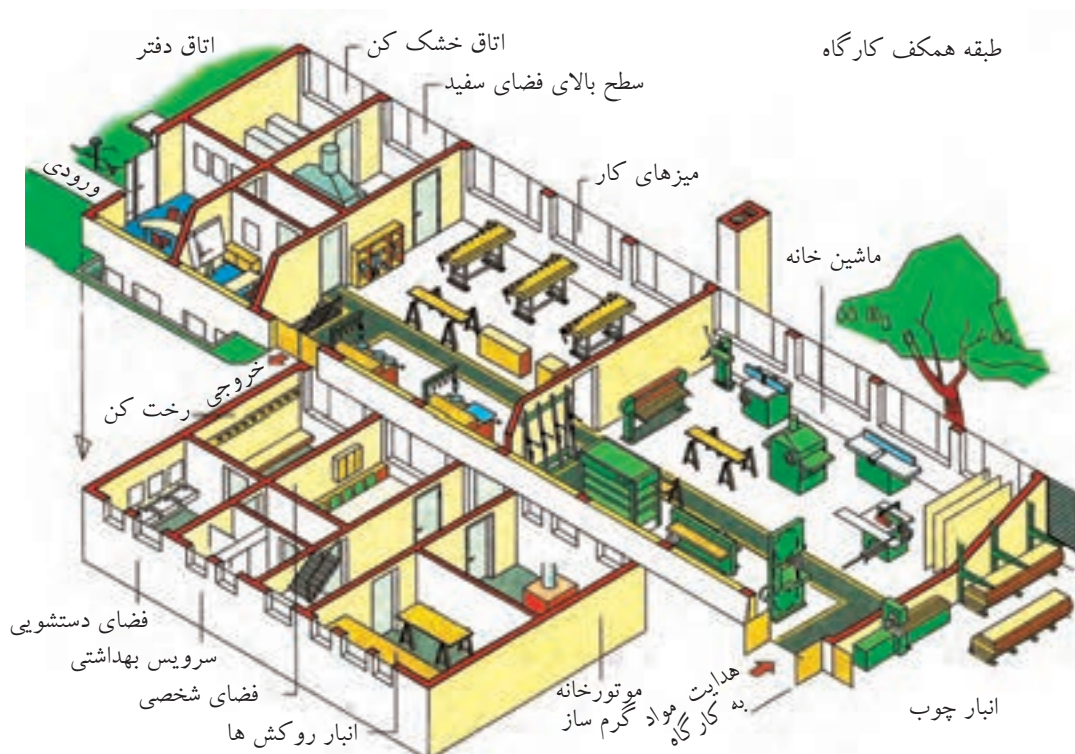
شکل (۴-۶۰) نقشه استقرار ماشین آلات و تاسیسات و میز کار و مواد در تصویر مجسم از کارگاه بزرگ صنایع چوب
