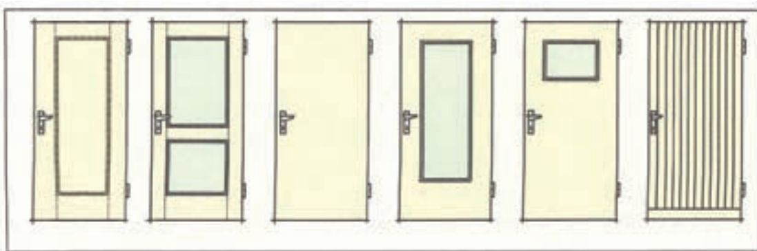
شکل (۵-۱۱۸) نقشه نمای انواع درهای ورودی در طرح های مختلف قاب و شیشه و قاب و تنکه و دوجداره
