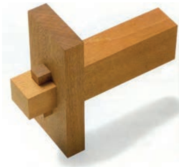
شکل (۳-۱۳۷) تصویر مجسم اتصال میانی کم و زبانه با گوه
