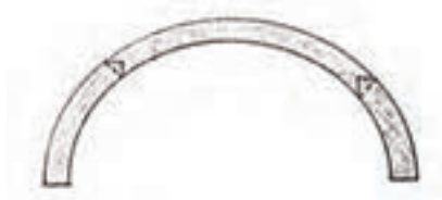
شکل (۳-۱۳۴) اتصال طولی قطعات قوس دار
