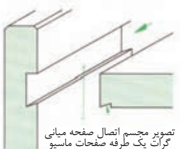
شکل (۳-۱۴۱) تصویر مجسم اتصال صفحه‌ای ماسیو گرات یک طرفه صفحات ماسیو
