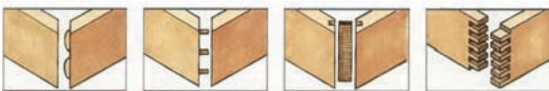
شکل (۵-۴۷) اتصال گوشه‌ای تصویر مجسم اتصالات انگشتی، قلیف زبانه جدا، دویل و بیسکوییتی
