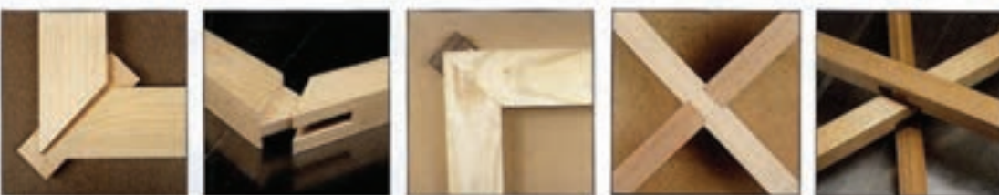
اتصال متقاطع اتصال دور و فارسی با زبانه جدا (قلیف) اتصال دور و فارسی اتصال دور و فارسی با زبانه جدا (قلیف) اتصال دور و فارسی
