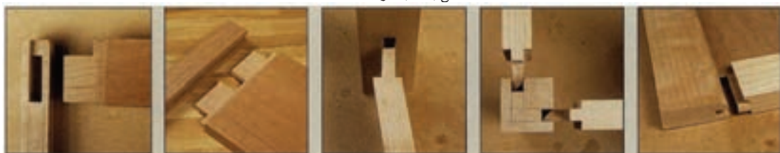
اتصال کم و زبانه کوله دار اتصال کم و زبانه دوزبانه اتصال کم و زبانه کج کم و زبانه کوله دار اتصال کم و زبانه باز شکل (۲-۵) موارد ۶ تا ۱۰
