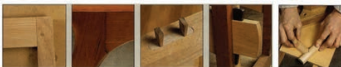
اتصال میانی آلت چینی اتصال گوه ای اتصال میانی با گوه فاق و زبانه با دویل شکل (۳-۵) موارد ۱ تا ۵
