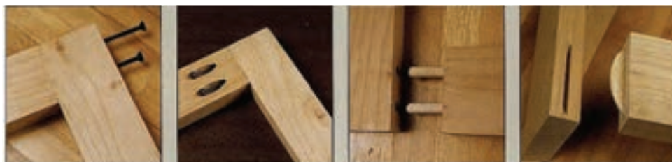
تصویر مجسم اتصال گوشه‌ای بیسکوییتی ساده تصویر مجسم اتصال دوبل تصویر مجسم اتصال گوشه‌ای مورب با پیچ تصویر مجسم اتصال با پیچ چوب
