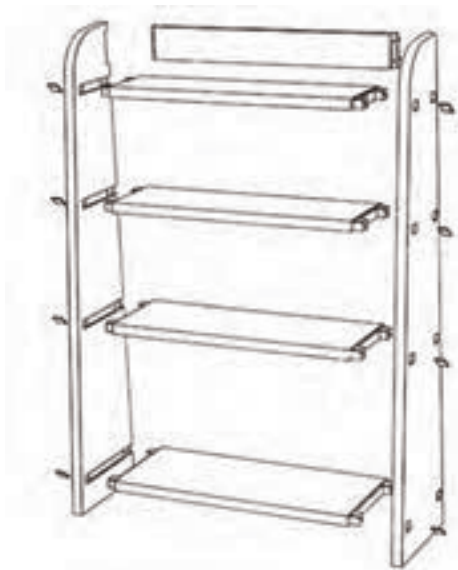
شکل (۵-۲۶) تصویر مجسم انفجاری کابینت طبقه‌بندی ماسیو کاربرد اتصالات گوشه‌ای و میانی کم و زبانه کوله‌دار مخفی و کم و زبانه‌های متوالی
