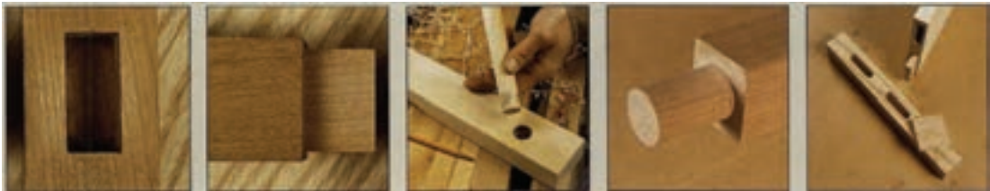
اتصال کُم و زبانه اتصال دویل سر خود اتصال دویل جدا شکل (۱-۵) موارد ۱ تا ۵
