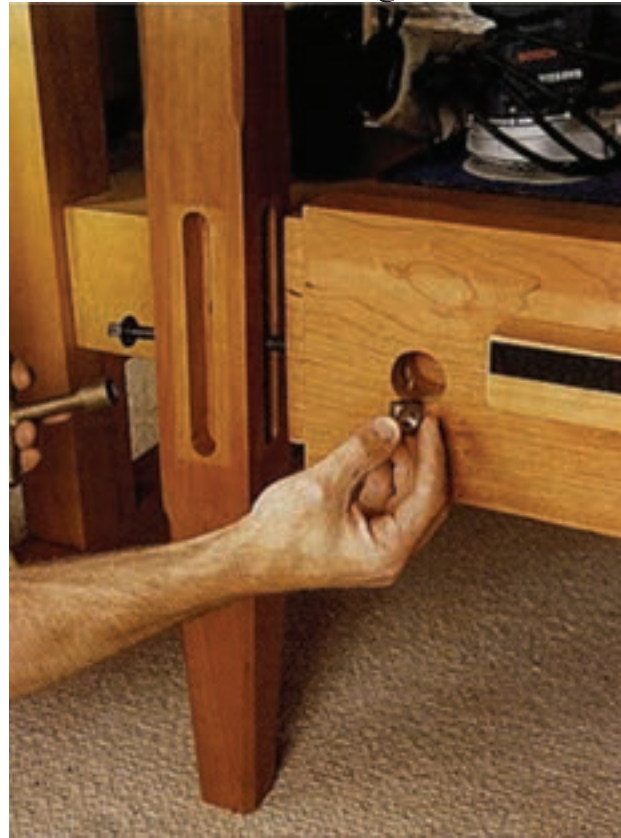
شکل (۲۲-۵) اتصال قید به پایه تختخواب به وسیله یراق فیتینگ (پیچ و مهره)
