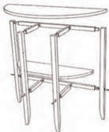
شکل (۵-۲۵) تصویر مجسم انفجاری کنسول کاربرد اتصالات گوشه‌ای و میانی کم و زبانه مخفی و باز با گوه
