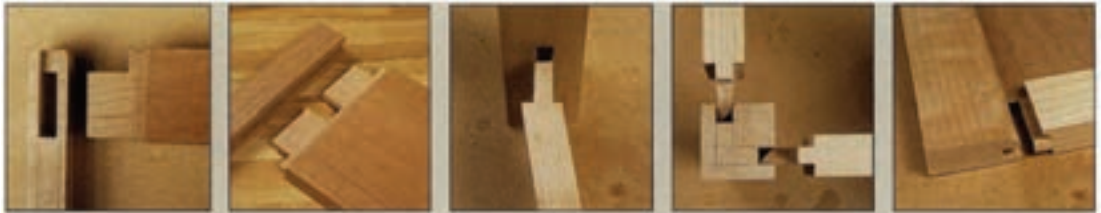
اتصال کُم و زبانه اتصال کُم و زبانه باز کُم و زبانه کوله دار قید به پایه مبلمان اتصال کُم و زبانه کج شکل (۲-۵) موارد ۶ تا ۱۰
