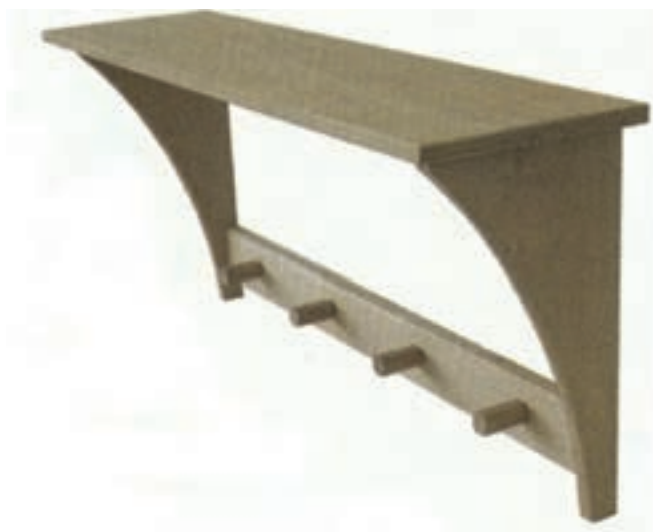
شکل (۳-۱۶۷) تصویر مجسم ایزومتریک جالباسی دیواری
