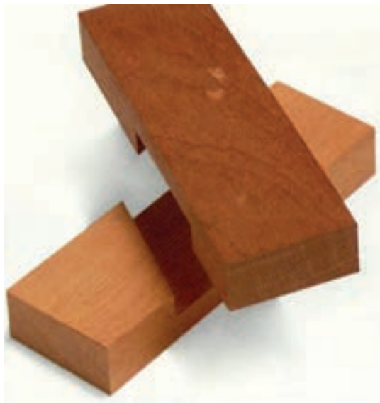
شکل (۳-۱۶۱) تصویر مجسم اتصال متقاطع با زاویه کمتر از ۹۰ درجه (نیم نیم)
