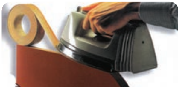
شکل ۴-۱۶ - نوار کردن لبه‌های قوس‌دار توسط اتو
