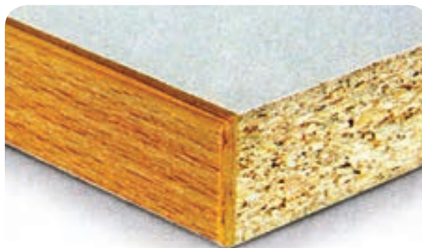
شکل ۴-۲- لبه نئوپان‌ها فاقد زیبایی و صافی هستند.
