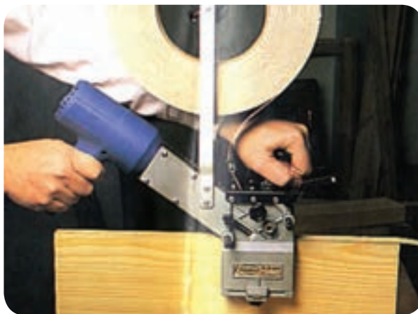
شکل ۴-۱۹ - نحوه نوار کردن با سشوار
