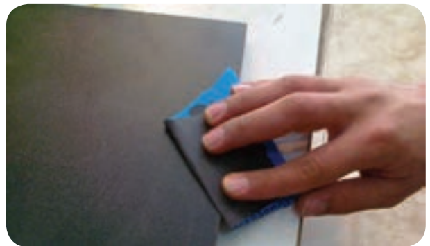
شکل ۴-۳۰ - پرداخت لبه لبه‌های نوار شده با سنباده
