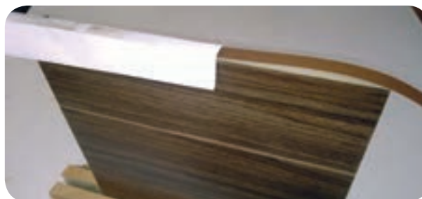
شکل ۴-۱۴ - نحوه استفاده از کاغذ در زیر اتو
