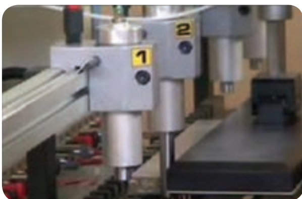
شکل ۳-۷ - قطعه کار، توسط جک‌ها گونیا شده است.
