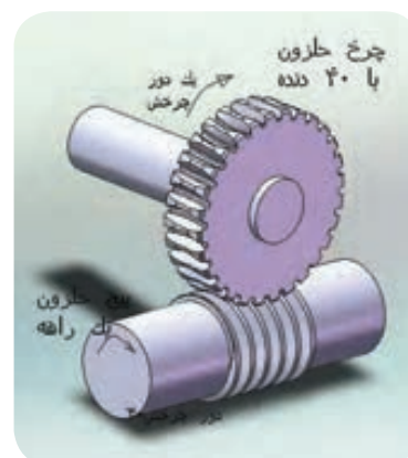
سیستم چرخ حلزون و پیچ حلزون
