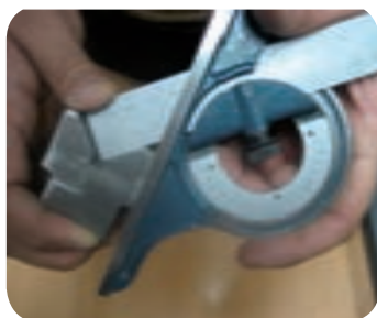
کنترل شیب قطعه با زاویه سنج انیورسال
