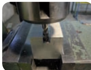
شیار تراشی با تیغه فرز انگشتی
