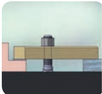
استفاده از یک تسمه برای توزیع نیرو
