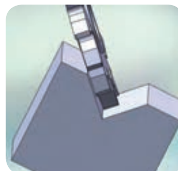
ایجاد شیارهای V شکل با تیغه فرز پولکی
