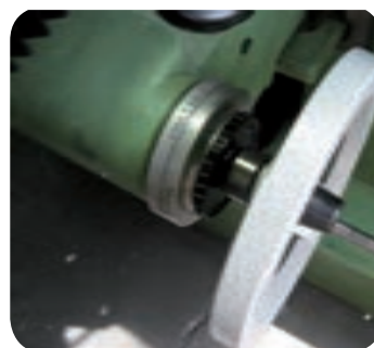
صفر کردن ورنیه های فلکه ها پس از مماس کردن ابزار با قطعه کار
