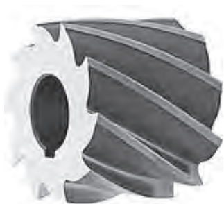
تیغه فرز غلطکی با دنده های مارپیچ
