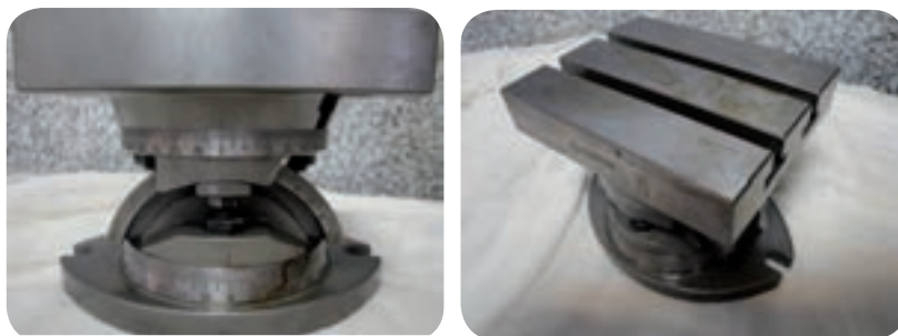
میز زاویه دار قابل تنظیم
