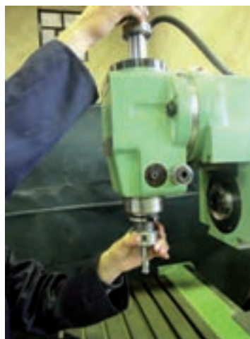
نحوه بستن کُلت بر روی دستگاه
