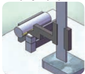
اندازه گیری عمق شیار
