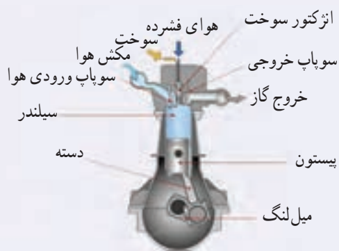
شکل ۳۳.۵ طرحی از اجزای یک ماشین دیزل
