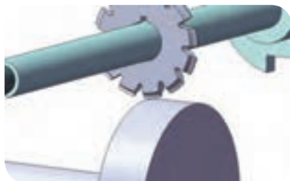
مماس کردن تیغه فرز بر روی قطعه کار
