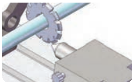
منطبق کردن تیغه فرز با مرکز قطعه کار
