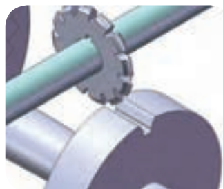
زدن اولین شیار چرخ‌دنده با حرکت طولی میز ماشین
