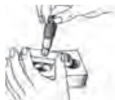
کنترل عمق سوراخ با استفاده از میکرومتر
