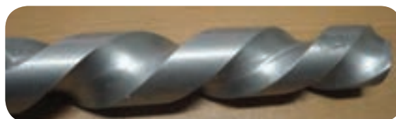
ایجاد شیار مارپیچ در یک میله گرد
