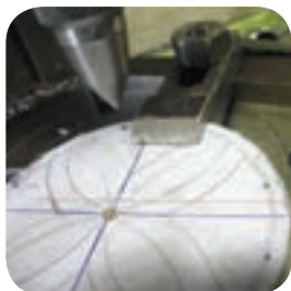
بستن قطعه با روپنده بر روی میز گردان
