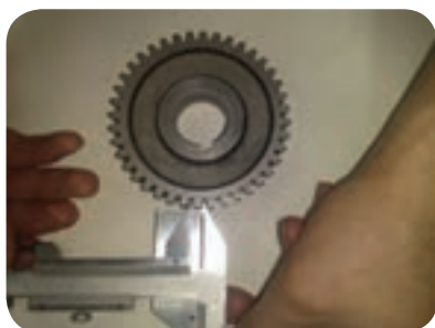
کنترل دقیق ضخامت چرخ‌دنده‌ی ساده با کولیس دنده‌سنج
