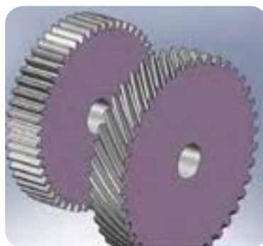
تفاوت دنده چرخ‌دنده ساده و مارپیچ
