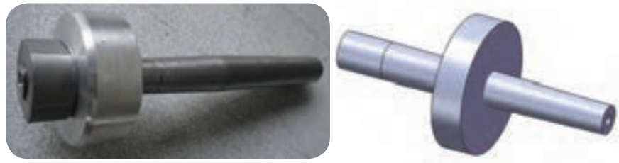
سوار کردن قطعه بر روی محور مخروطی
