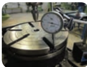
میله مخروطی جهت هم محور کردن گلویی دستگاه و مرکز گیره
