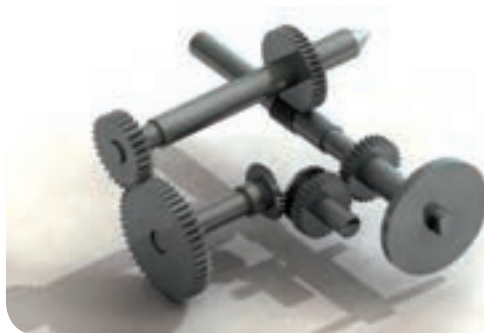
سیستم انتقال دور بین قطعه کار و صفحه سوراخ‌دار در روش اختلافی
