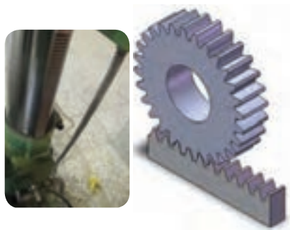
کاربرد چرخ و شانه در ماشین‌های مته
