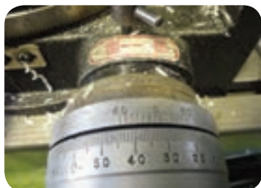
حلقه مدرج دستگیره میزگردان برای جابجایی دقیق‌تر
