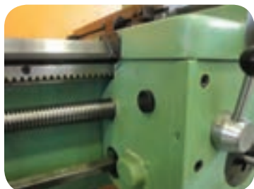
کاربرد چرخ و شانه در ماشین‌های تراش
