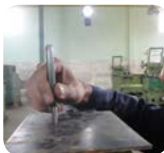
طرز صحیح گرفتن سنبه نشان نسبت به سطح قطعه کار
