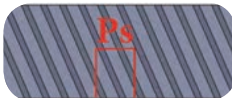
معرفی گام ظاهری در چرخ‌دنده شانه‌ای مایل
