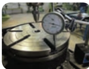
کنترل افقی بودن سطح میزگردان با ساعت اندازه‌گیری
