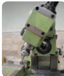
انحراف کله‌گی در صورتیکه از ماشین فرز عمودی برای چرخ‌دنده مارپیچ استفاده شود
