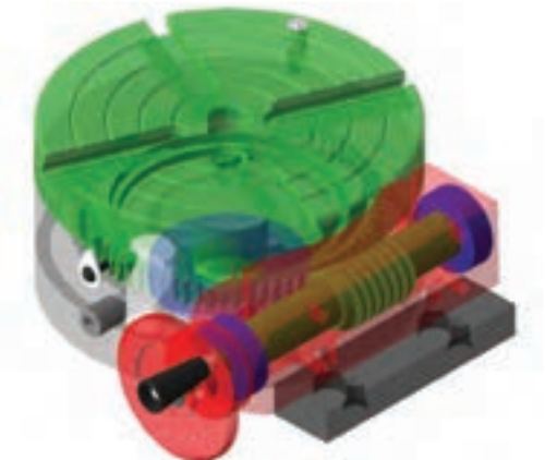
نمایش سیستم داخلی میزگردان
