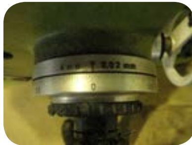
صفر کردن ورنیه دستگاه
