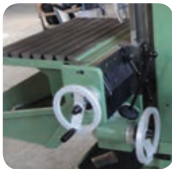
مکانیزم جابجایی میز ماشین
