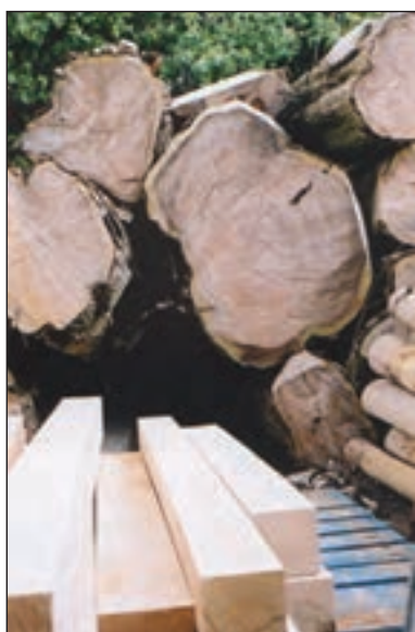
شکل ۱-۱۵۹ بالای تصویر گرده بینه - پایین تصویر الوار
