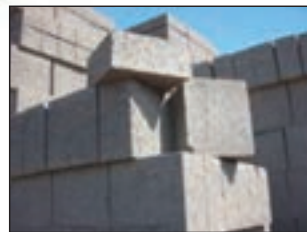
شکل ۷۹-۱ انواع بلوک بتنی سبک
