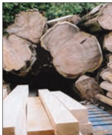
شکل ۱۹-۱ چوب های گرده بینه و چهارتراش
