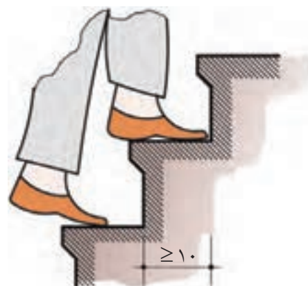
شکل ۱۶-۳ کوچک ترین اندازه ی کف پله در پله های پیچ
