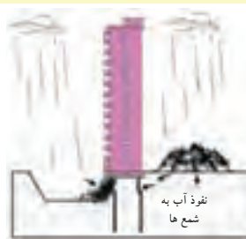
۳- تغییر مکان ناگهانی ساختمان و گسیخته شدن شمع ها در اثر فشار جانبی متغیر
