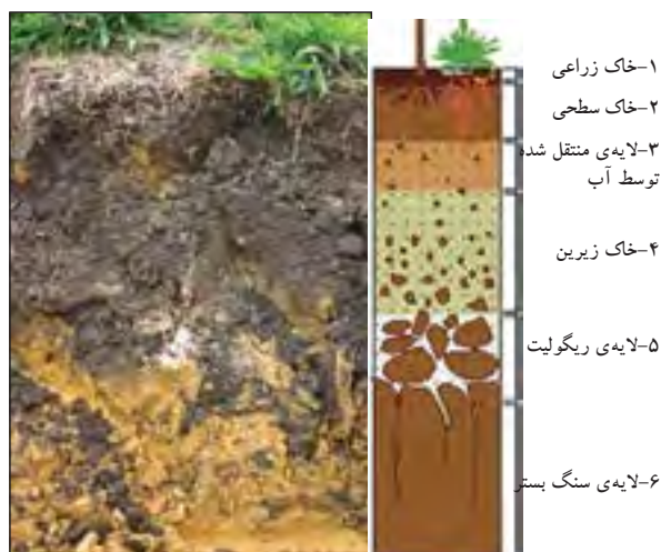
شکل ۱-۲ لایه های مختلف خاک با دانه بندی متفاوت
