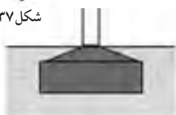
شکل ۱-۳۹ پی بتنی هرمی با زاویه ۳۰ درجه
