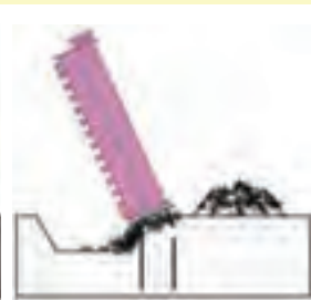
۴- شکسته شدن شمع ها و سقوط ساختمان به سمت جنوبی
