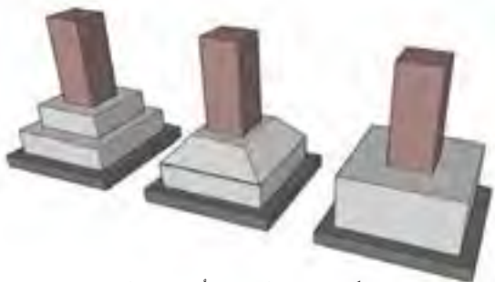
شکل ۱-۴۷ نمایش سه بُعدی پی های بتنی مسلح منفرد ساده، هرمی، پلکانی
