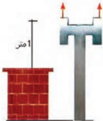
شکل ۱ - ۶۲: نصب صحیح لوله دودکش داخل اتاق
