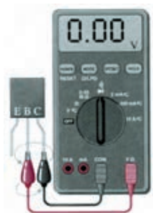
شکل ۵۰-۱۲ ترانزیستور معیوب (اتصال کوتاه)
