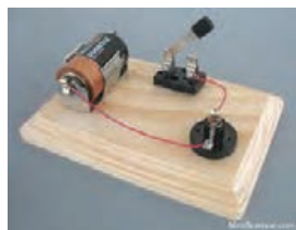
شکل ۱-۳۰ یک مدار الکتریکی ساده
