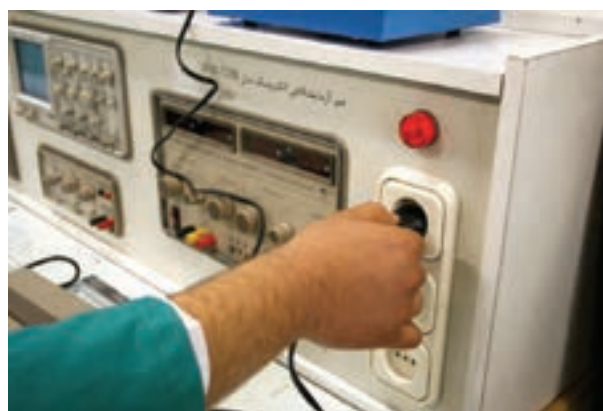
شکل ۱-۳۸ اتصال صحیح دو شاخه
