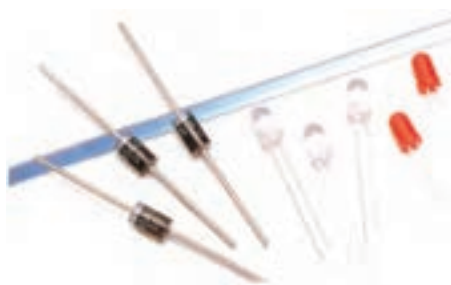
شکل ۱۰-۲۰ نمونه هایی از انواع دیودها
