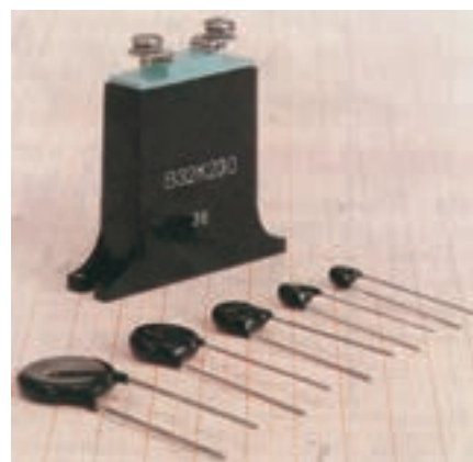
شکل ۱۴-۲ شکل ظاهری واریستور و نماد آن
