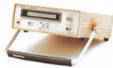
شکل ۵۴-۱ یک نمونه LC متر
