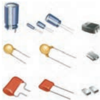
شکل ۷-۱۵ شکل ظاهری چند نمونه خازن
