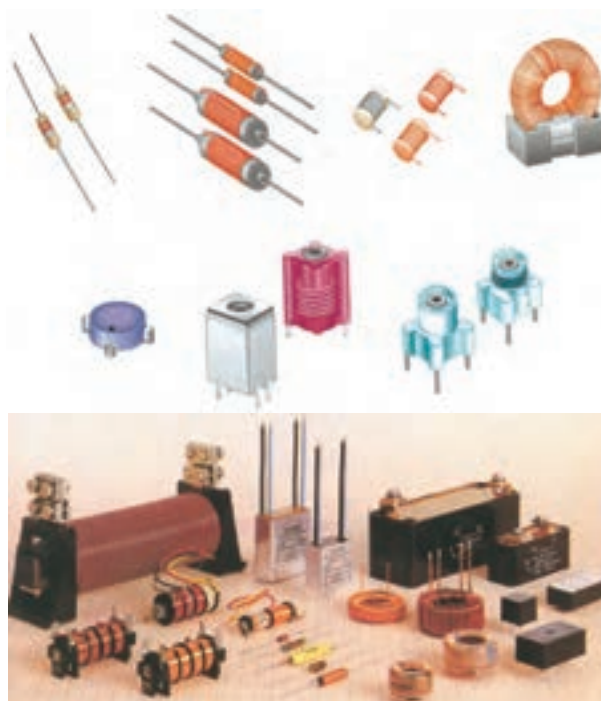
شکل ۸-۳۱ چند نمونه سلف ثابت و متغیر
