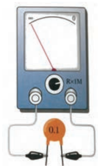
شکل ۷-۵۱ خازن قطع است
