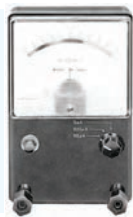
شکل ۲۶-۳: یک نمونه گالوانومتر صفر وسط
