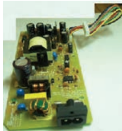
شکل ۷-۱۳ قرار گرفتن ورودی‌ها در یک طرف و خروجی‌ها در طرف دیگر
