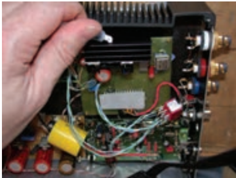
شکل ۷-۱۴ محل نصب هیت سینک
