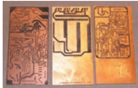
شکل ۷-۶ انتقال مدار چاپی روی فیبر
