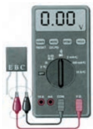
شکل ۵۰-۱۲ ترانزیستور معیوب (اتصال کوتاه)
