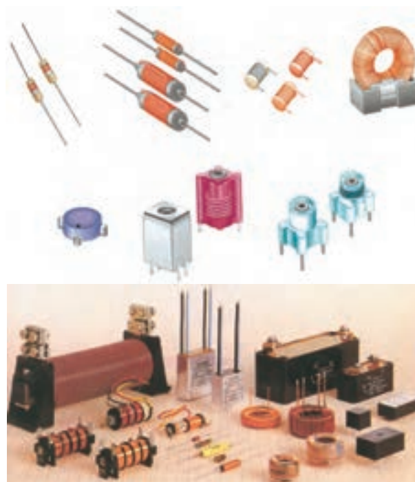
شکل ۸-۳۱ چند نمونه سلف ثابت و متغیر
