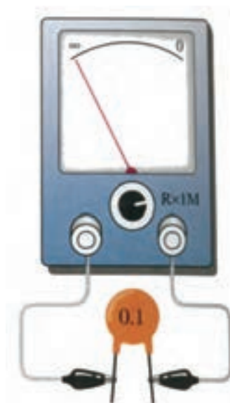
شکل ۷-۵۱ خازن قطع است
