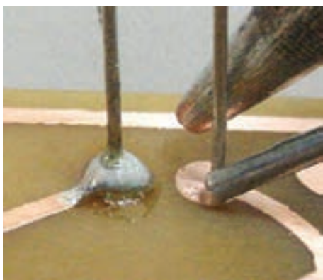
شکل ۷-۱۰ مونتاژ قطعات روی فیبر
