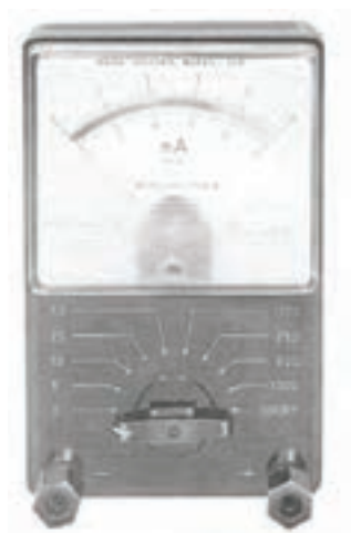
شکل ۱۹-۱ یک نمونه آمپر متر
