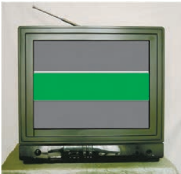
شکل ۲-۱۱۶- تصویر تلویزیون وقتی C518 قطع است.
