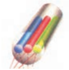
شکل ۱-۹۳- سیستم تولید اشعه In Line
