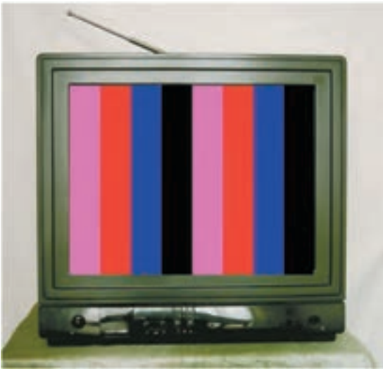
شکل ۲-۱۳۷- تصویر نوار رنگی استاندارد بدون رنگ سبز
