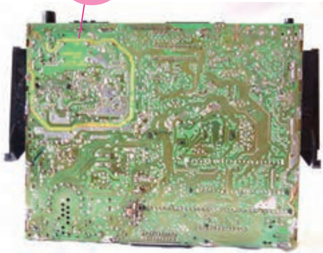
شکل ۳۱-۲ برد مدار چاپی تلویزیون
