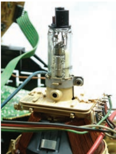
شکل ۱-۷۱-الف - شکل لامپ تصویر و پایه‌های آن
