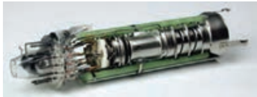
شکل ۱-۵ تفنگ الکترونی تلویزیون رنگی
