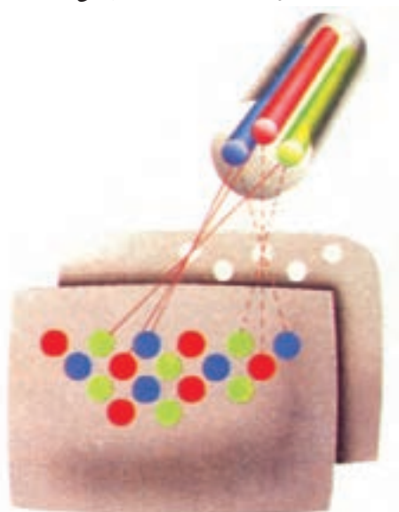
شکل ۱-۲۰ تفنگ الکترونی لامپ تصویر مثلثی ( \Delta )
