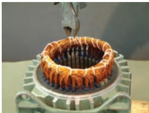
شکل ۲-۱۳ - چیدن نخ‌های کلاف‌بندی با سیم‌چین
