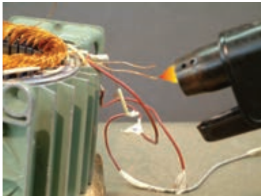
شکل ۴-۱-ب - پاک کردن لاک به روش سوزاندن
