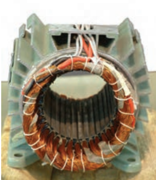
شکل ۴-۱۷- نمایش استاتور نخ‌بندی شده از دو سمت
