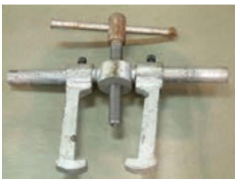
شکل ۱-۴۸- ابزار درآوردن بوش و یاتاقان‌های استوانه‌ای
