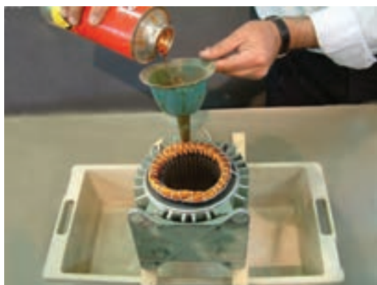
شکل ۲۵-۴ – ریختن شارلاک روی سیم‌ها
