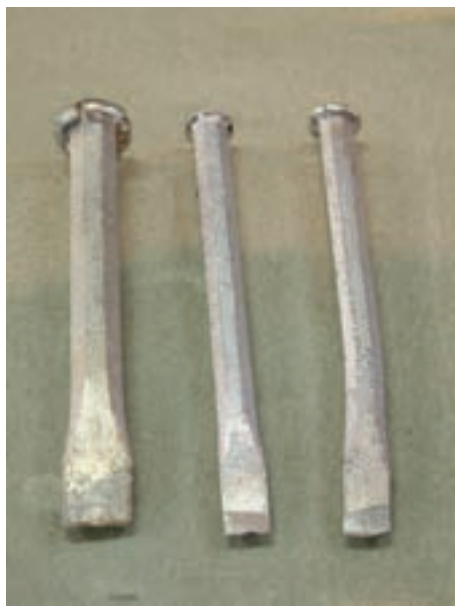
شکل ۲-۱۹- چند نمونه قلم برای بریدن سیم‌ها
