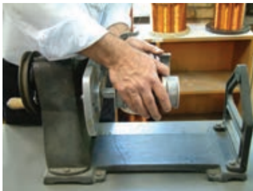
شکل ۱۸-۳ - باز کردن قالب‌ها
