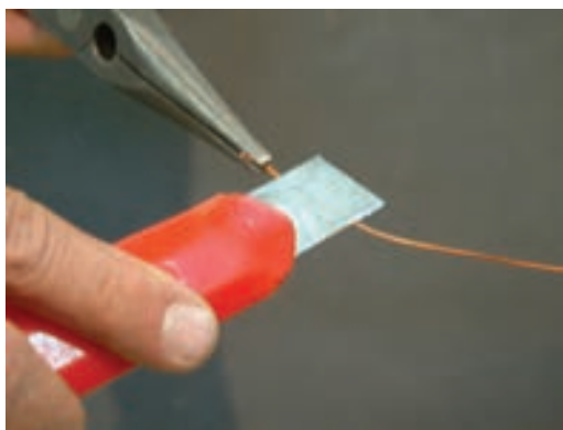
شکل ۴-۱-ج - پاک کردن لاک به روش تراشیدن
