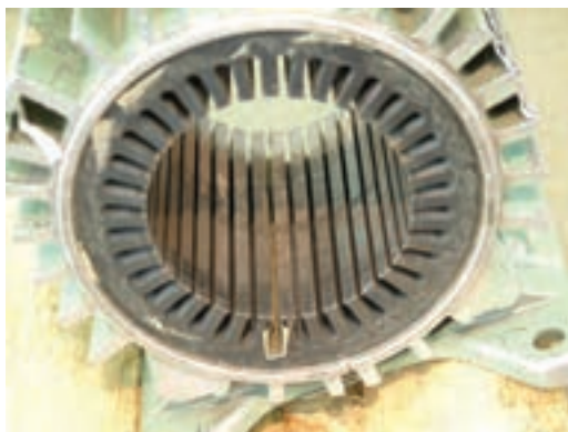
شکل ۲-۳۶ – آزمایش عایق در داخل شیار
