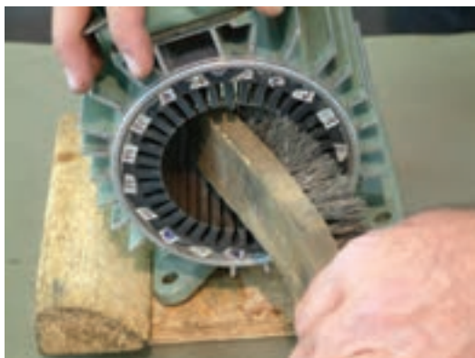
ب – تمیز کردن استاتور با برس سیمی
