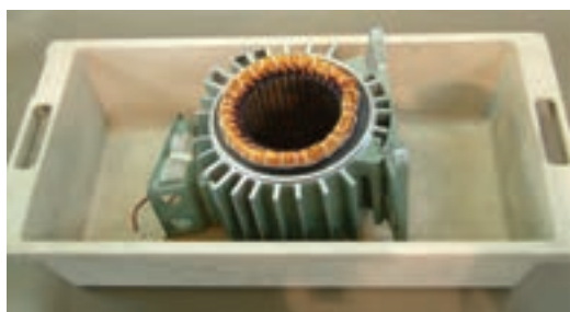
شکل ۲۱-۴- قرار دادن استاتور در درون وان شارلاک
