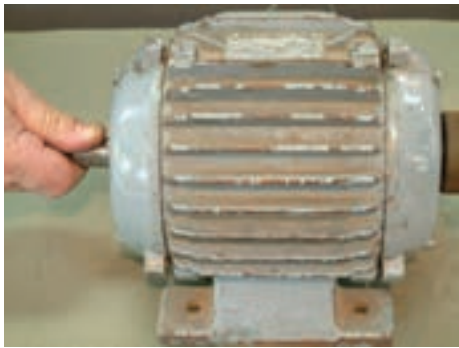
شکل ۱-۴۵- بررسی لقی بوش‌ها
