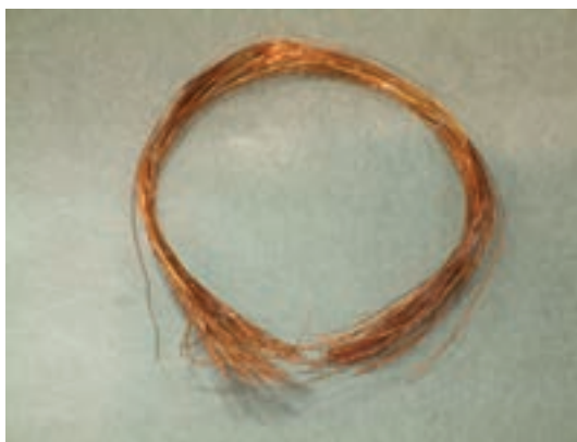
شکل ۱۶-۳- الف - شمارش تعداد دور هر بوبین
