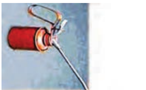
شکل ۱-۳۴- روغن کاری یاتاقان ها
