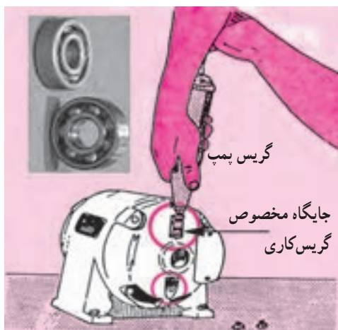
شکل ۱-۳۳ - گریس کاری بلبرینگ‌ها
