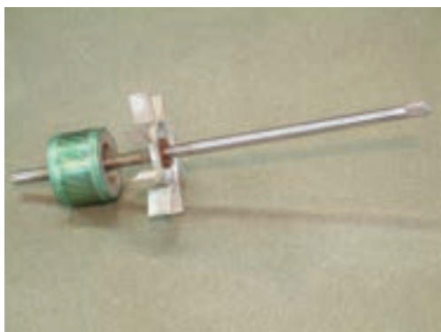
شکل ۱-۲۸- پروانه‌ی نصب شده روی محور روتور
