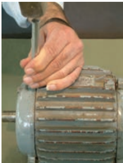
شکل ۱-۲۳- علامت گذاری روی پوسته و درپوش‌ها
