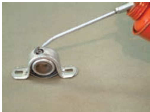
شکل ۱-۳۴- روغن کاری یاتاقان ها
