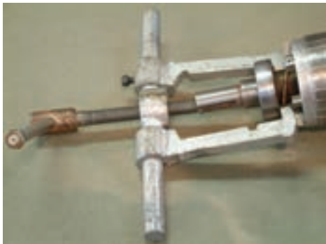
شکل ۱-۴۶- استقرار بلبرینگ کش روی محور روتور
