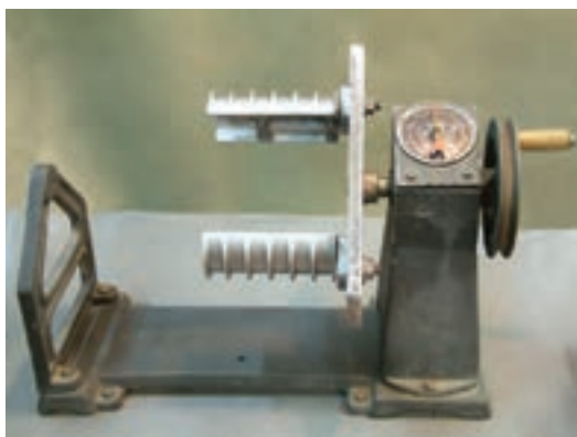
شکل ۱۵-۳- تنظیم اندازه‌ی قالب‌ها در کلاف پیچ
