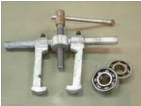
شکل ۱-۴۷- بلبرینگ‌ها پس از جدا شدن از محور
