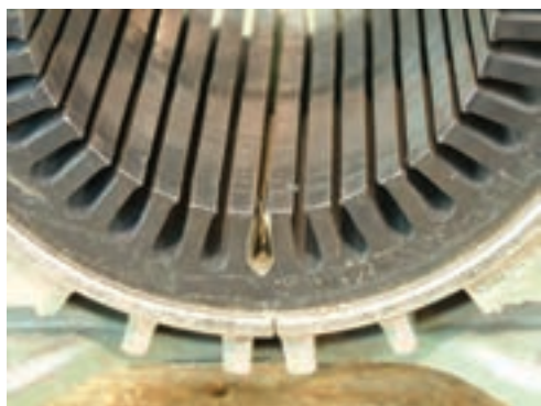
شکل ۲-۳۳- اندازه گیری محیط شیار
