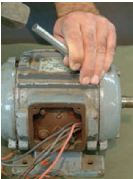
شکل ۱-۲۶- باز کردن درپوش موتور
