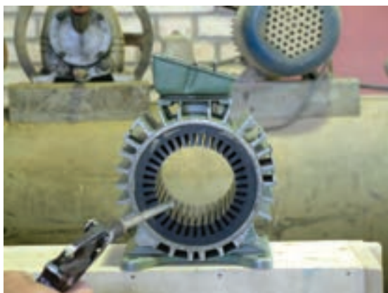
شکل ۱-۳۱ - بادگیری قطعات جدا شده
