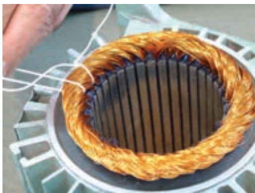
شکل ۴-۱۵- عبور نخ از شیارها و گره خوردن آن
