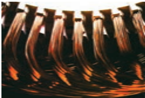
شکل ۲-۳۰- عایق گذاری بین طبقات
