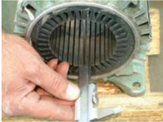
شکل ۲۶-۲- اندازه گیری محیط داخلی و طول شیار
