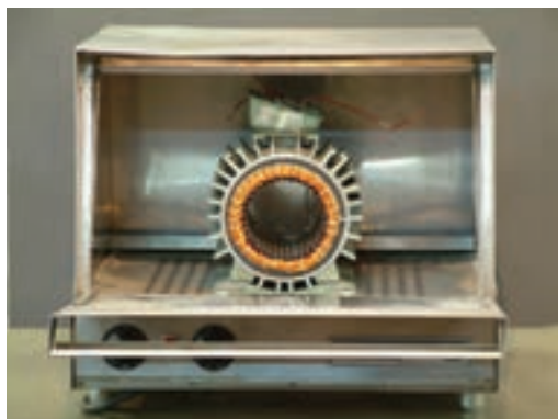
شکل ۲۰-۴- گرم کردن استاتور
