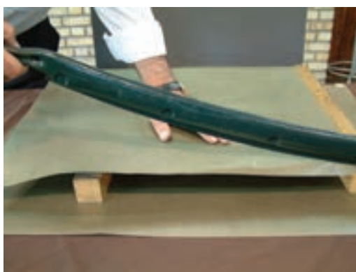
شکل ۲۹-۲ - کاتر یا دستگاه برش‌دهنده‌ی عایق‌های برشمان
