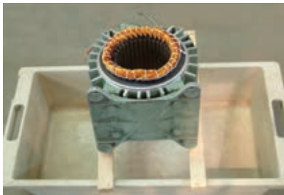
شکل ۴-۲۲- خارج کردن اضافات شارلاک از استاتور
